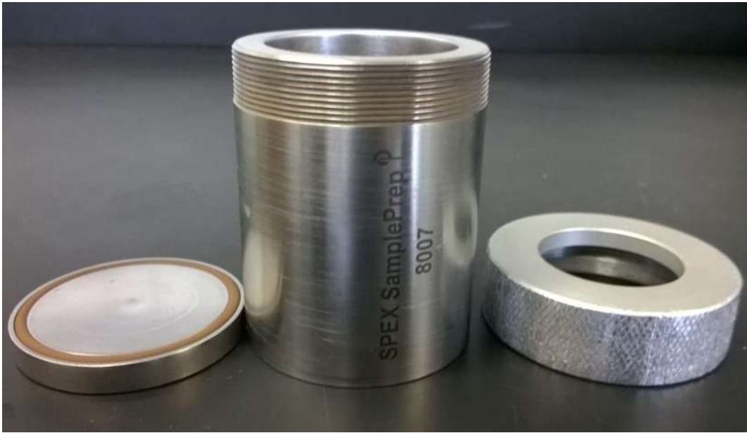
Figura 4.4. Cilindro de acero Spex Sample Prep 8007.
