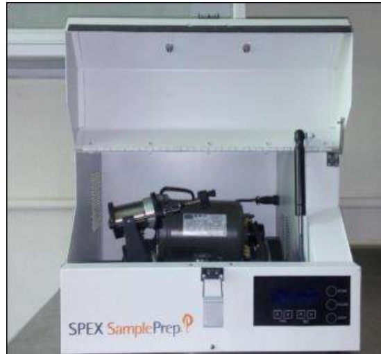
Figura 4.6. Molino vibratorio de bolas de alta energía, es decir, energía suficiente para inducir una reacción.
