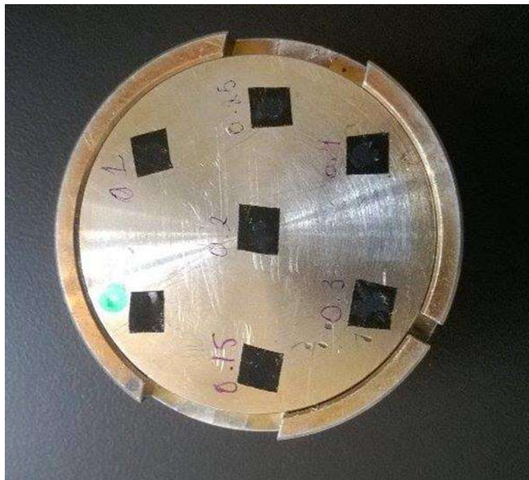
Figura 5.16. Porta muestras donde se observa la cinta que contiene las diferentes muestras a las que se someterán a Microscopía electrónica de barrido.
