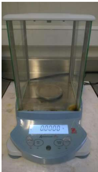
Figura 4.2. Balanza analítica de alta precisión de 0.001g.
