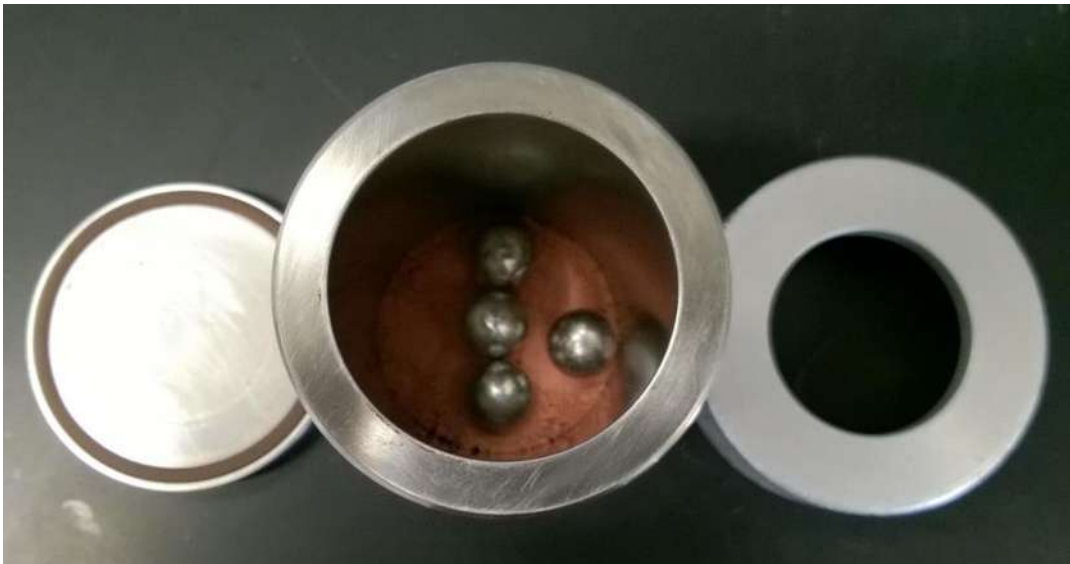
Figura 4.5. Vista del interior del cilindro, donde se percibe la muestra y los balines.
