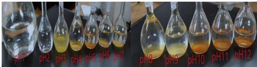
Figura 4.52. Precipitación de sulfato férrico a distintos pH de 1 a 12
