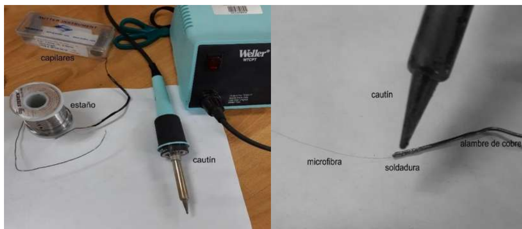
Figura 3.4. Realización de la soldadura microfibras de carbono - alambre de cobre
