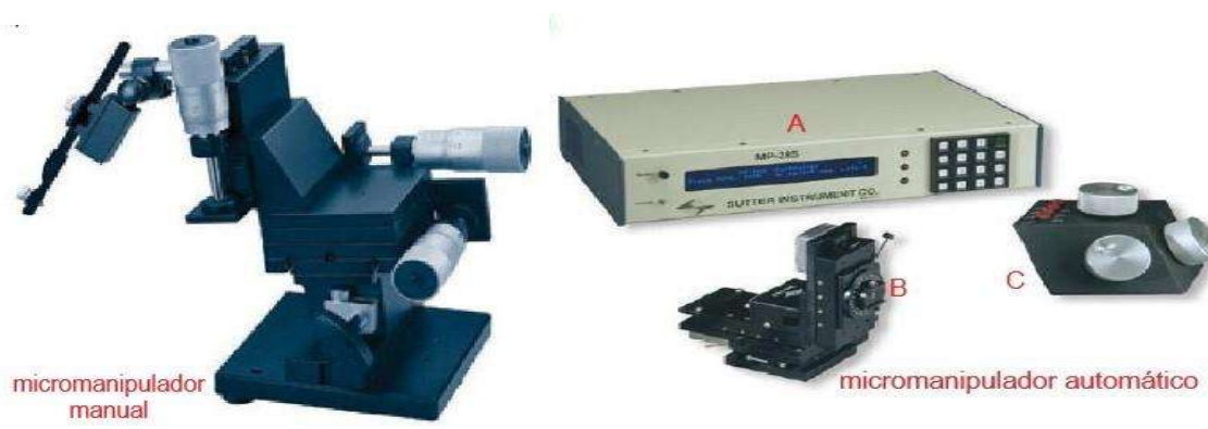
Figura 3.3. Micromanipuladores; (A), controlador automático con teclado para programación; (B), actuador con un servomotor; (C), mando manual
