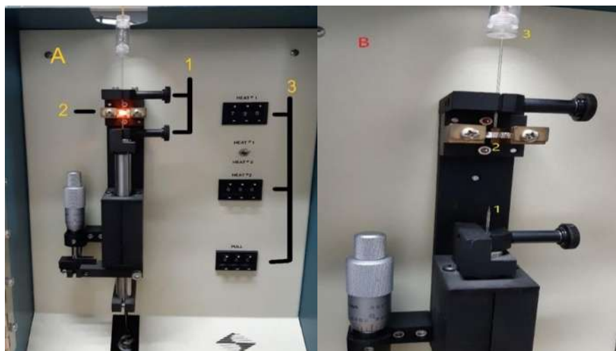
Figura 3.5. Estirador de micropipeta. (A); proceso de estiramiento de la punta, el capilar sostenido por sujetadores (1) y calentando por un filamento de platino (2), la temperatura controlada por controladores (3). (B); capilar cortado en dos puntas separadas (1) y (2). La punta (2) se contiene en su interior la microfibras de carbón (3).
