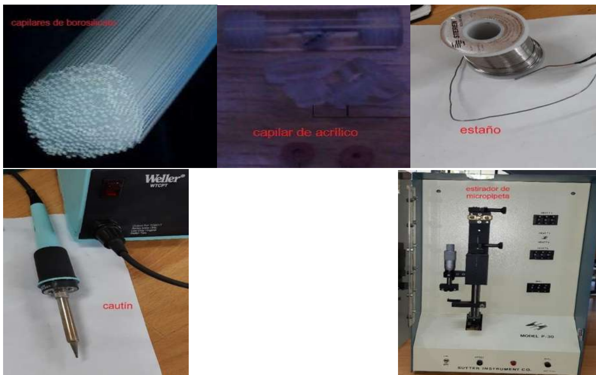
Figura 3.1. Lista de materiales necesarios para fabricar el microelectrodo
