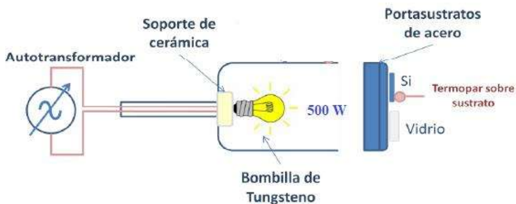
Figura: 14 Esquema del calentador construido en el laboratorio (Dagoberto Cardona).
