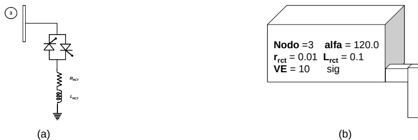
Figura 3.34 Objeto formado a partir del horno de arco del sistema de prueba
