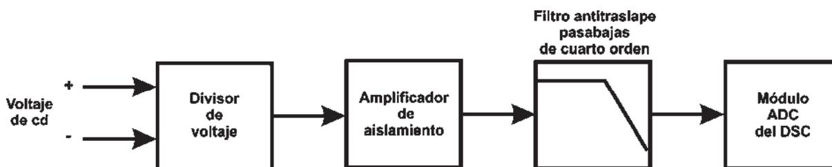
Figura 3.19 Diagrama a bloques para la medición del voltaje de *cd*.
