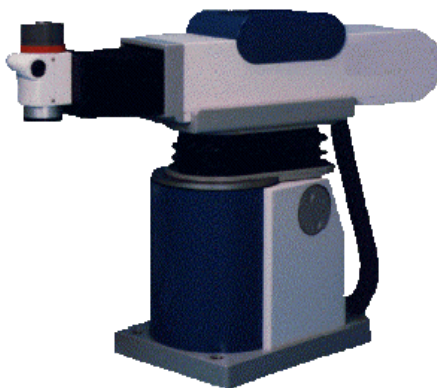
Figura 2.5 Robot en configuración cilíndrica.
