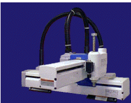
Figura 2.4 Robot en configuración cartesiana.
