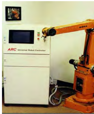
Figura 1.3. Robot Irb6, construido por ASEA
