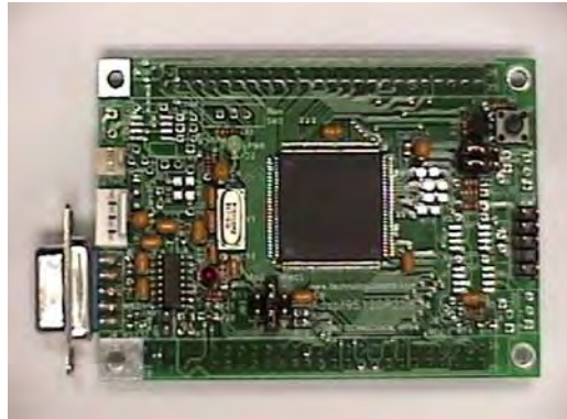
Figura 1.6: Imagen del módulo Adapt9S12DP256 del microcontrolador 68hcs12 [Arts04].
