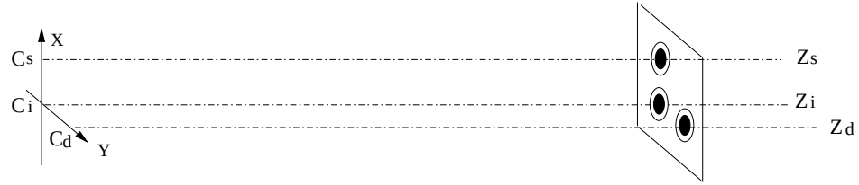
Figura 4.6: El patrón de alineación consiste únicamente en tres marcas que guarden una misma relación geométrica que las cámaras del sistema estéreo.
