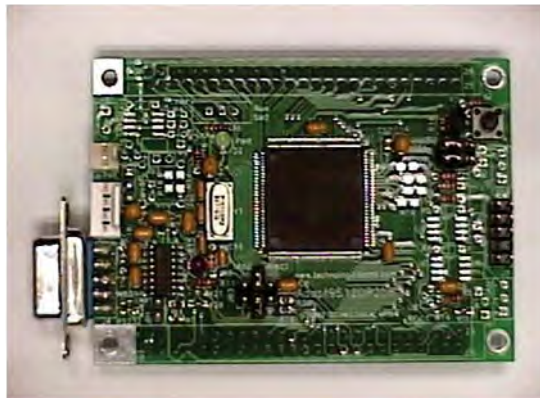
Figura 5.2: Módulo Adapt9S12DP256 del microcontrolador 68hcs12 [Rodriguez08]
