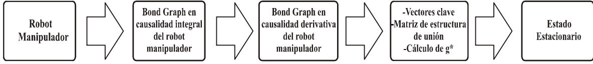
Figura 5.4: Diagrama de flujo para el cálculo de la respuesta en estado estacionario en un enfoque de Bond Graph.
