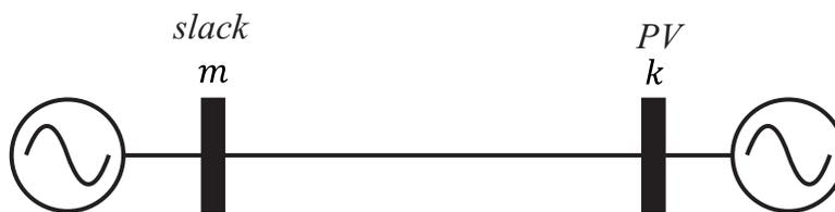
Figura 3.2: Sistema de dos nodos, *slack-PV*.
