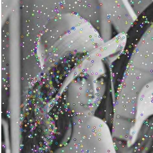
Figura 5.1: En blanco puntos de interés generados con datos primitivos de C y OpenCV, Círculos con variedad de colores, puntos de interés generados por funciones métodos de OpenCV optimizadas
