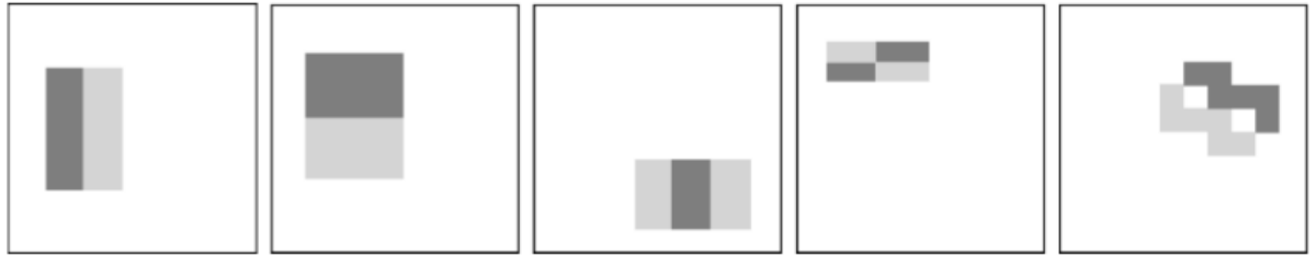
Figura 2.5: Conjunto de filtros rectangulares utilizados por Viola [Viola et al., 2005] para extraer características usadas en el Framework Adaboost. Cada filtro es compuesto por tres regiones, blanco, gris claro, gris oscuro con peso asociados 0, -1 , y 1 respectivamente, con el fin de calcular las características en una ventana, estos filtros son convolucionados con la imagen.
