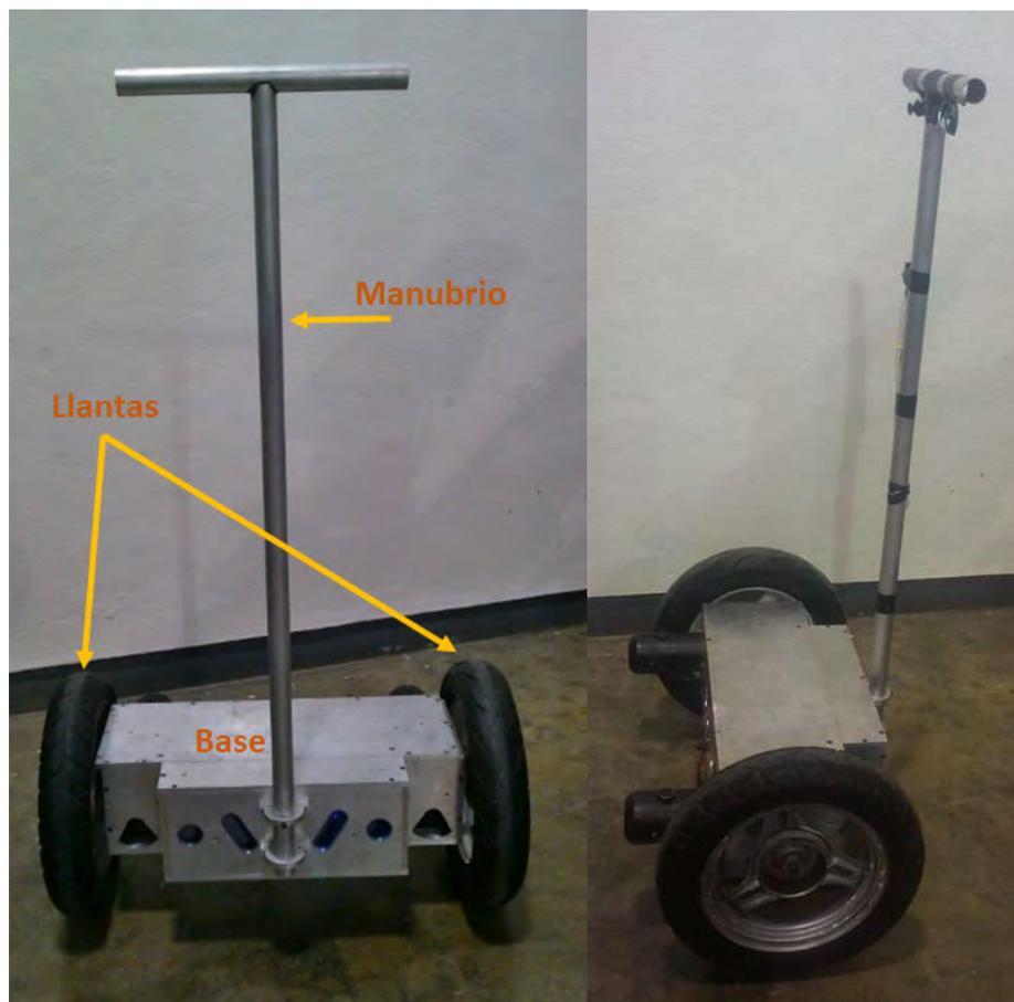
Figura 2.7: Prototipo construido
