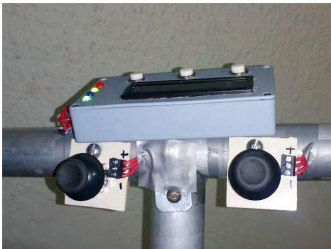
Figura 2.32: Joystick utilizado para el giro del vehículo.
