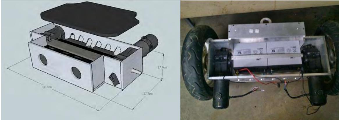
Figura 2.8: Base del prototipo
