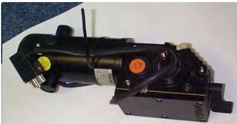
Figura 2.12: Motor FRACMO serie X01429/24 con su caja reductora
