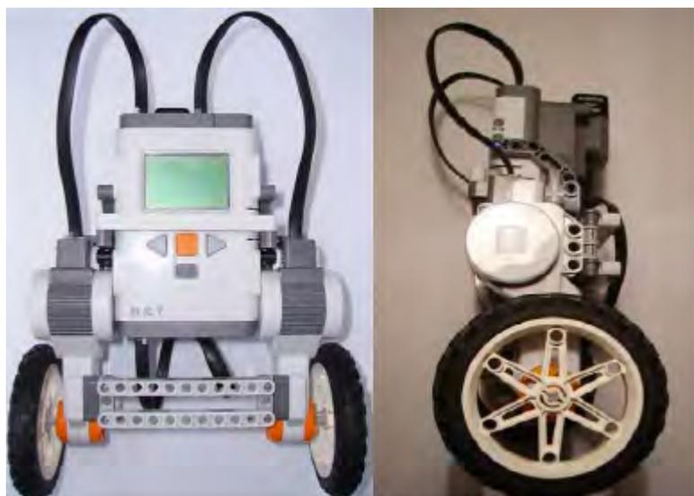
Figura 1.2: Péndulo invertido construido con Lego Mindstorm [LEGO M 2010]
