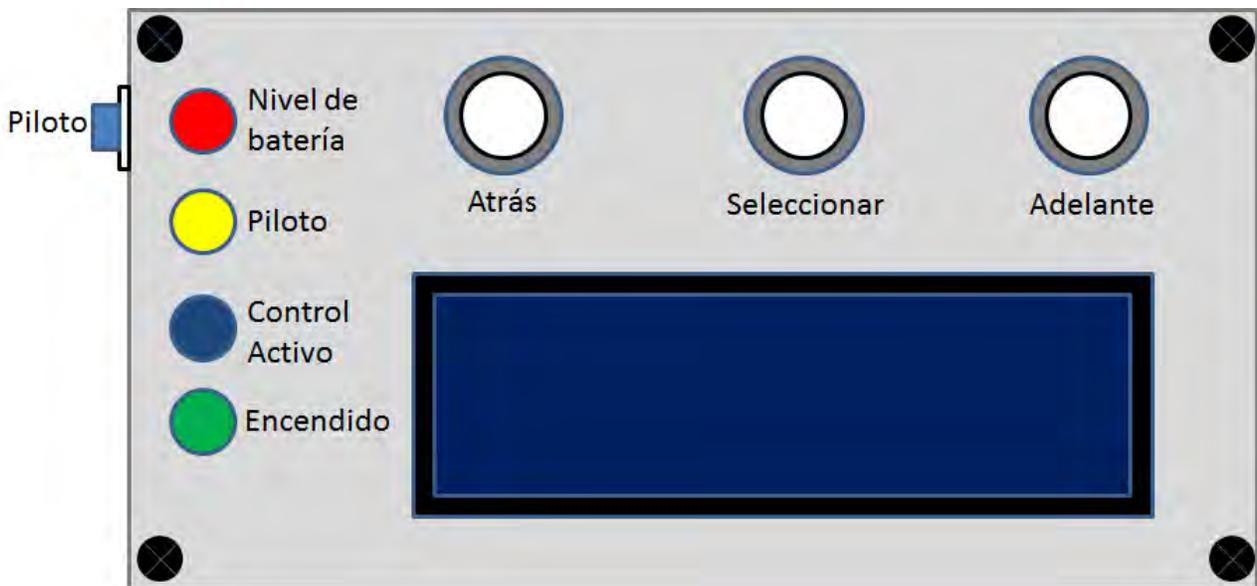
Figura 2.31: Panel de visualización y control del vehículo
