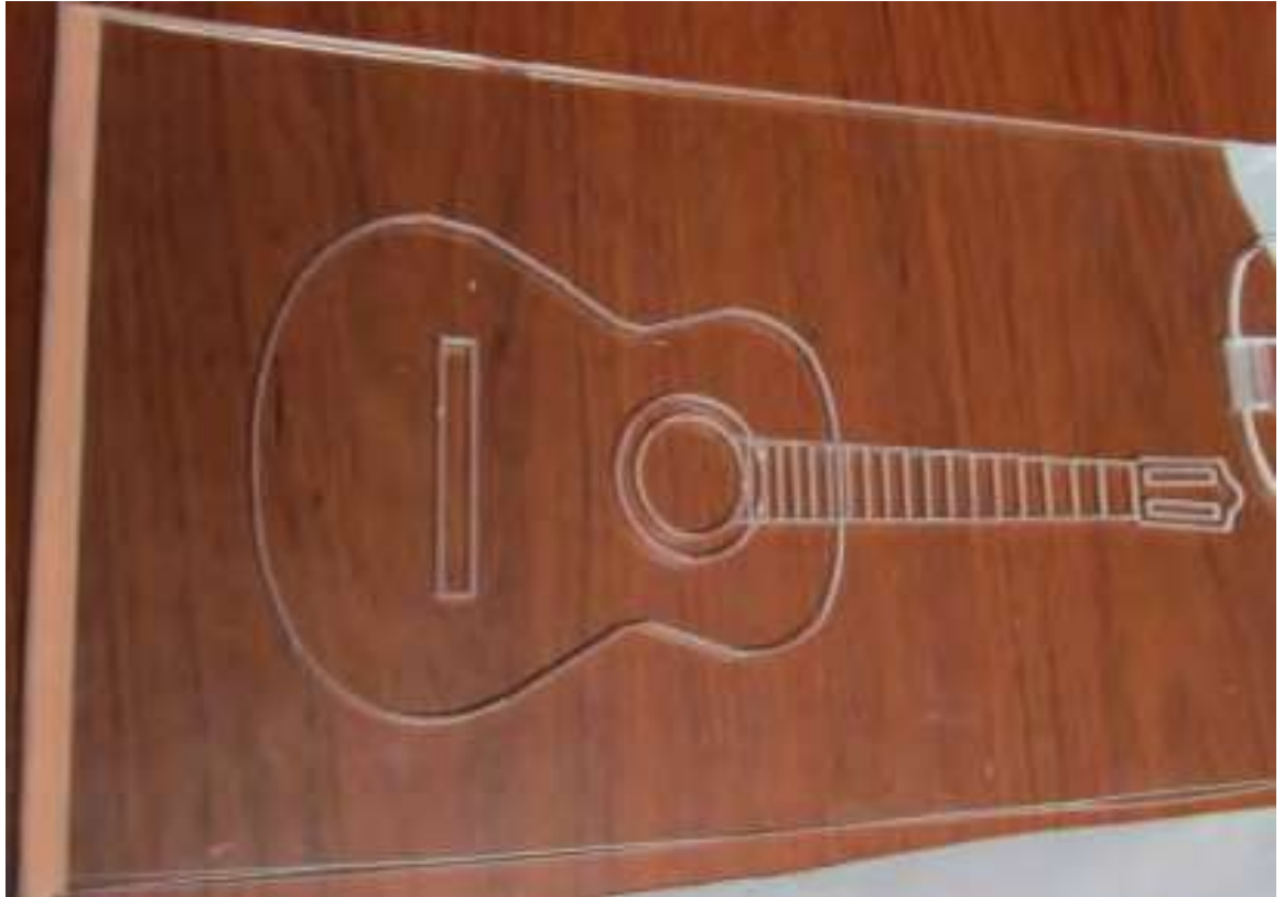
Figura 4.5: Resultado físico de trace2Gcode con T = 2.0 y N = 4.0 .
