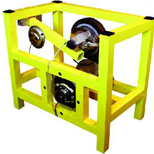
Figura 2.2: Prototipo de laboratorio del sistema de frenado ABS.
