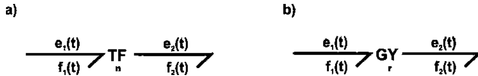
Figura 2.4: Representación en Bond Graph de a) un Transformador (TF) y b) un Girador (GY)
