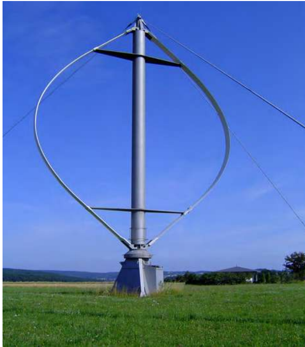
Figura 2.1: Turbina de eje vertical tipo Darrieus
