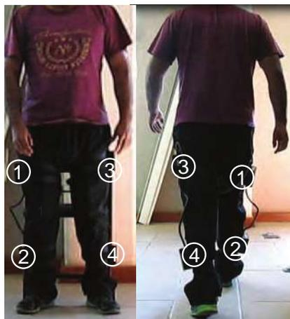
Figura 3.6: 1) Sensor cadera derecha, 2) sensor rodilla derecha, 3) sensor cadera izquierda, 4) sensor rodilla izquierda.
