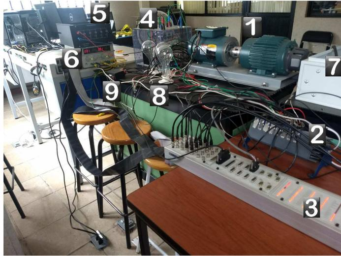
Figura 4.24: Experimento del control óptimo del PMSG.
