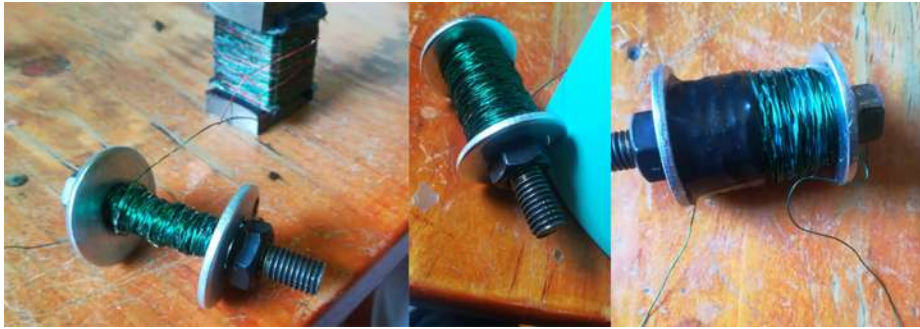
Figura 3.3: Elaboración del electroimán
