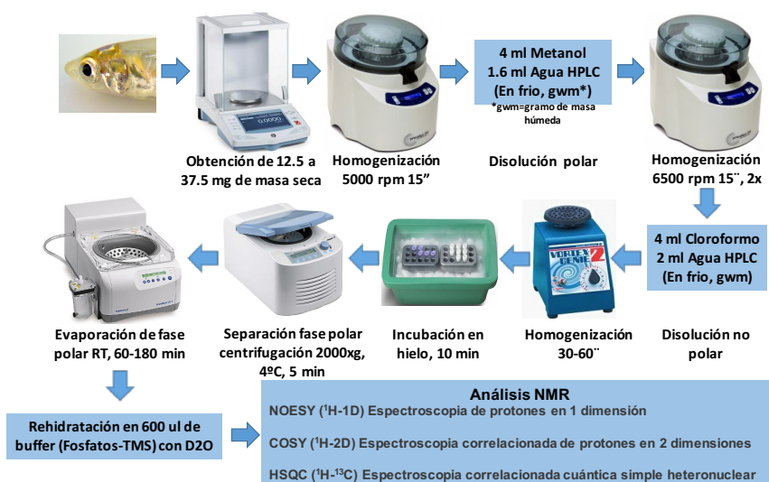
Figura 46. Proceso de extracción de metabolitos por el método de Metanol:Cloroformo:Agua para análisis de resonancia magnética nuclear en el pez blanco de Pátzcuaro C. estor .
