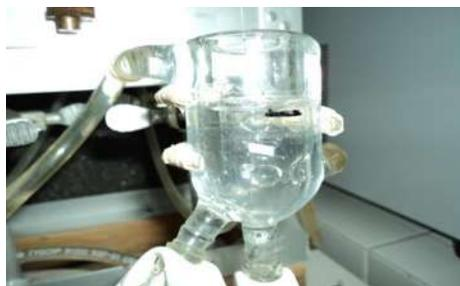
Figura 5. Cámara para órgano aislado. En esta imagen se muestra un anillo de aorta sostenido con dos ganchos de níquel-cromo; con uno de estos ganchos se fijó la preparación al fondo de la cámara y con el otro gancho se fijó a un transductor de tensión.
