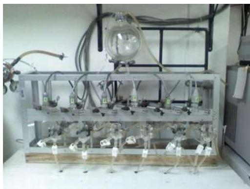
Figura 6. Equipo para órgano aislado. En esta imagen se observan las cámaras para órgano aislado y los transductores de tensión. Adicionalmente se observa el matraz balón de doble fondo que suministra la solución Krebs-Henseleit.
