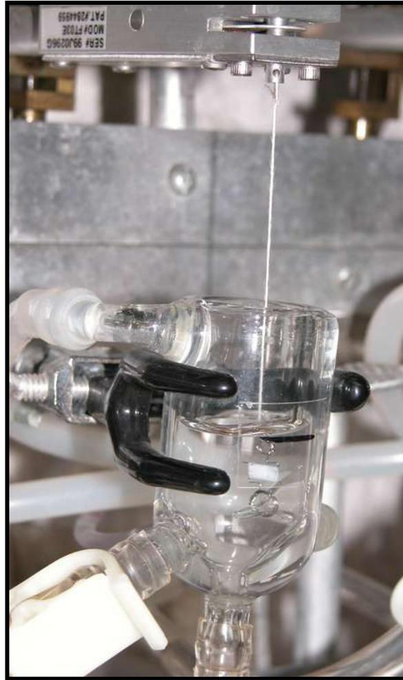
Figura 24.- Cámara para órgano aislado. En esta imagen se muestra un anillo de aorta sostenido con dos ganchos de nikrom; con uno de estos ganchos se fijó la preparación al fondo de la cámara y con el otro gancho se fijó a un transductor de tensión.
