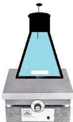
Figura 4. Sistema de auto-anaerobiosis. Consta de una parrilla de agitación con barra magnética un tapón de corcho y una aguja con salida de CO 2 .
