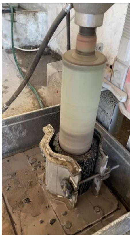
Figura 4.48: Proceso de extracción de núcleo.
