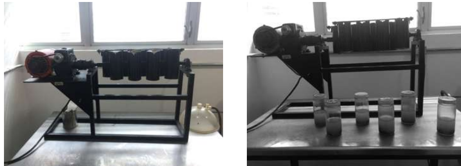
(a) Equipo de agitación mecánico (b) Frascos de vidrio después de 3 horas de agitación
