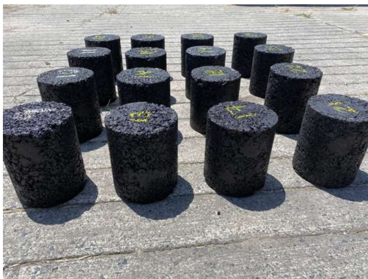
Figura 4.47: Especímenes para Módulo Dinámico de 170.2 mm de altura y 150 mm de diámetro.
