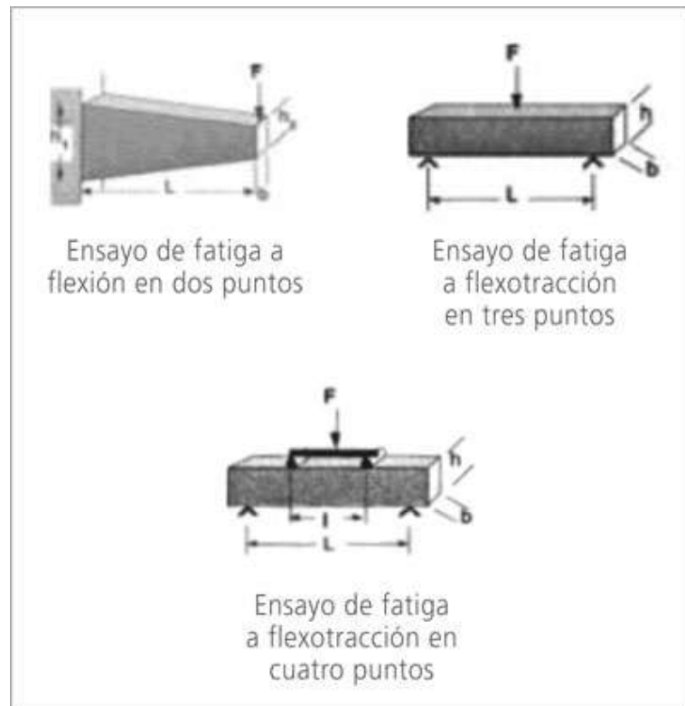
Figura 4.56: Procedimientos para determinar el comportamiento a fatiga en mezclas asfálticas (Fuente: Di Benedetto et al., 2003)
