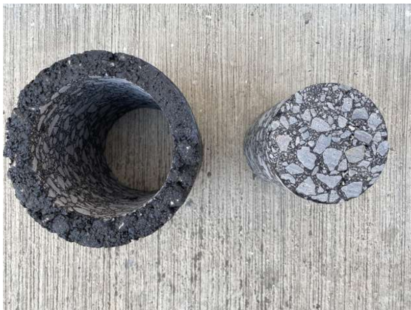
Figura 4.49: Núcleo después de extracción de 150 mm de altura y 100 mm de diámetro.
