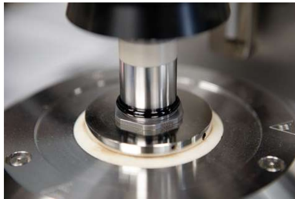
Figura 4.31: Aplicación del ligante entre platos paralelos del reómetro de corte dinámico
