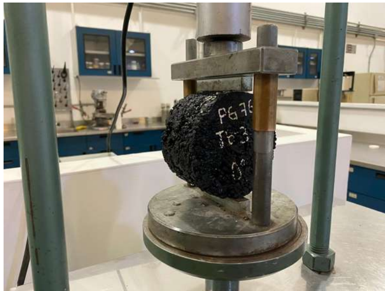
Figura 4.44: Prueba para determinar la resistencia a la tensión indirecta
