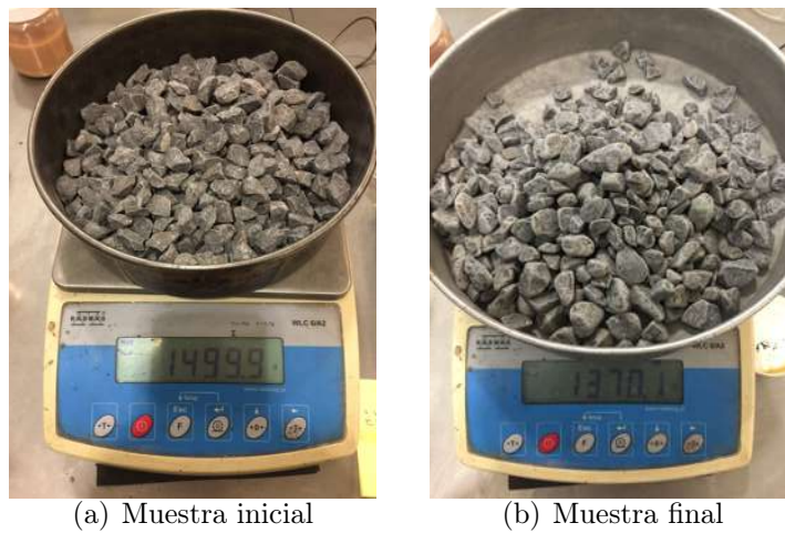
Figura 4.15: Desgaste del agregado pétreo en máquina Micro-Deval
