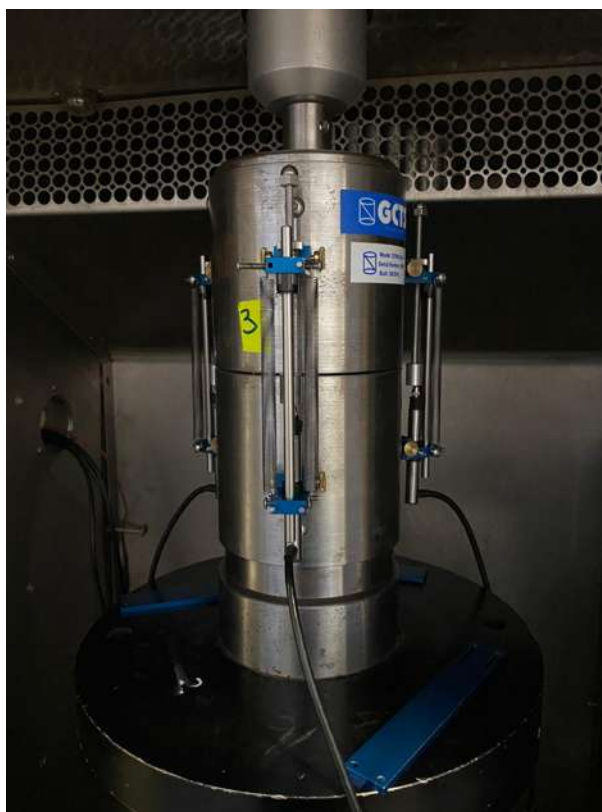
Figura 4.50: Calibración de prensa dinámica previo a evaluación.
