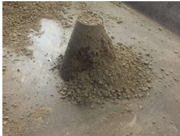
Figura 4.3: Condición SSS para agregado fino
