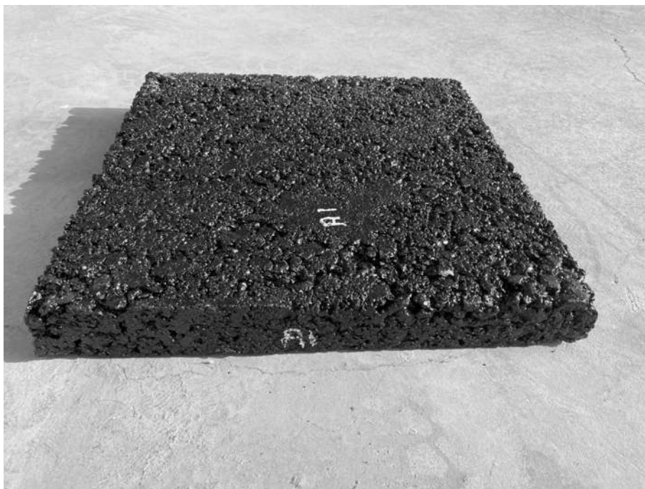
Figura 4.58: Losa de mezcla asfáltica antes de cortar especímenes para fatiga
