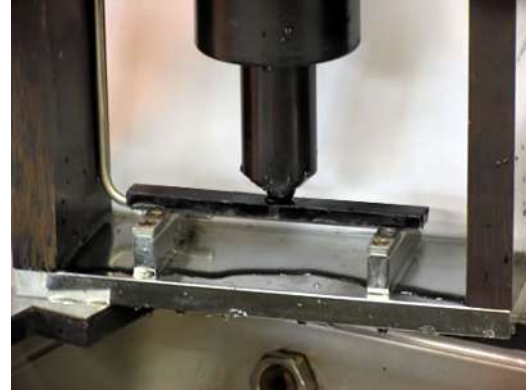
(b) Soporte de carga en equipo BBR
