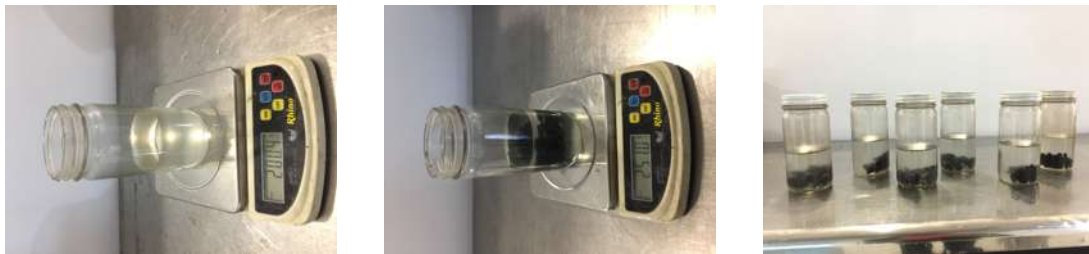
(a) 200 ml de agua destilada (b) 50 g de mezcla asfáltica (c) 15 horas de preparación de la muestra
