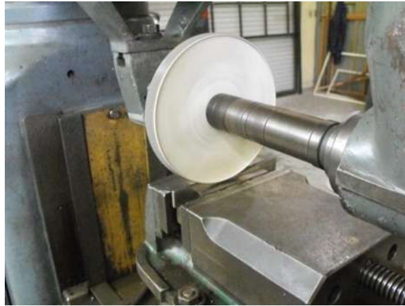
Figura 3.12 Lijado de las probetas con disco montado en fresadora manual.
