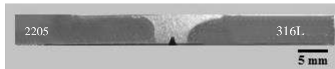
Figura 3.9 Probeta 7 de la junta 1 mostrando la muesca en la raíz de la soldadura.
