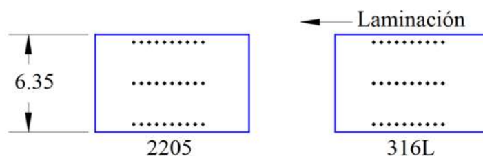
Figura 3.4 Tres barridos con 10 impresiones de microdureza HV_{100} realizado en los metales base, dimensiones en mm.
