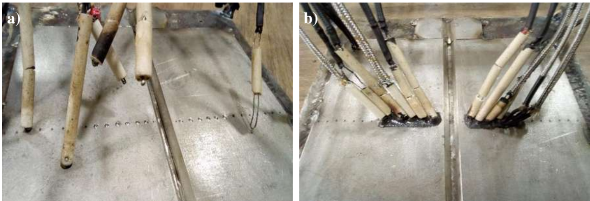
Figura 3.16 a) Junta a soldar con los barrenos maquinados b) Colocación de los termopares tipo K para la medición de temperatura en la ZAT durante el proceso de soldadura.
