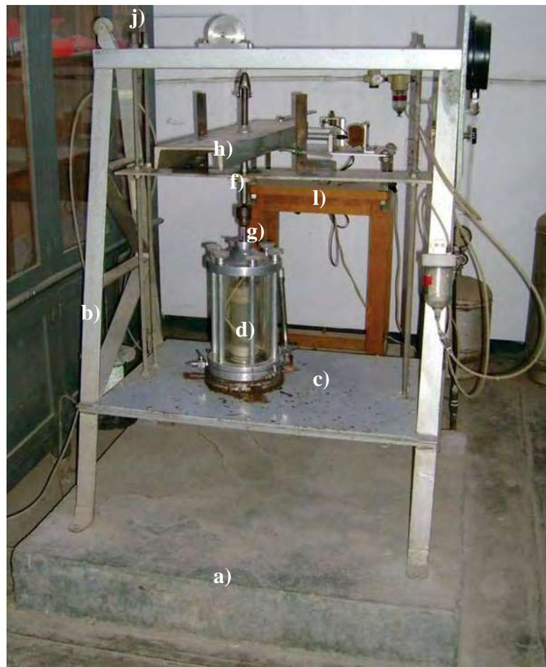
**Figura 2-1** Vista general del Péndulo de Torsión Libre de Zeevaert, instalado en el laboratorio de la FIC.
