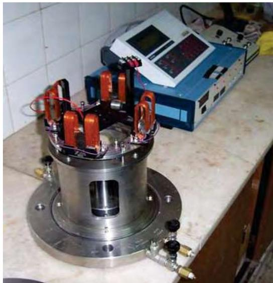
**Figura 1-14** Equipo para el ensayo de columna resonante.
