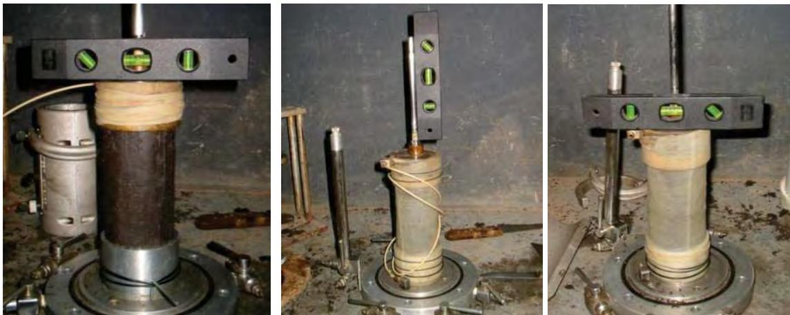
**Figura 5-17. Procedimiento en el montaje de la probeta de ensaye a la cámara triaxial.**
