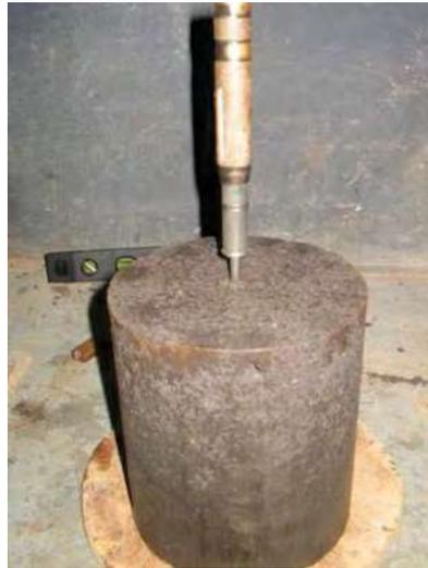
Figura 5-14. Determinación de  $q_u$ , del suelo remoldeado.
