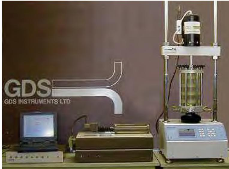
Figura 1-15 Equipo para realizar el ensaye triaxial cíclico.
