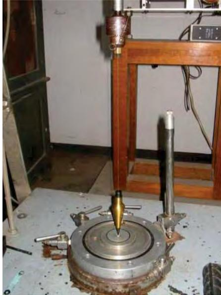
Figura 5-7 Centrado y nivelado de la placa base.
