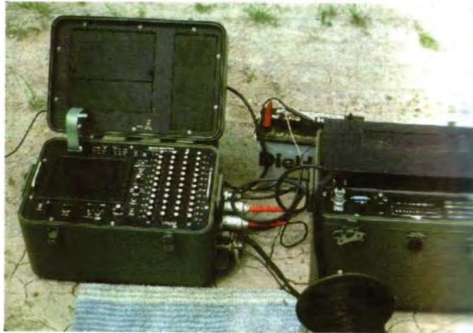
Figura 1-6 Equipo de medición para refracción sísmica.
