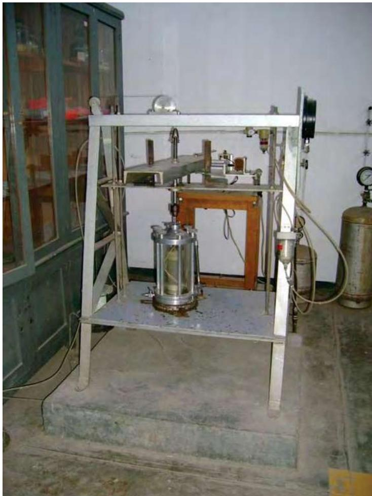
Figura 5-19. Vista general del PTL con la probeta de ensaye montada en la cámara triaxial y acoplada al sistema.
