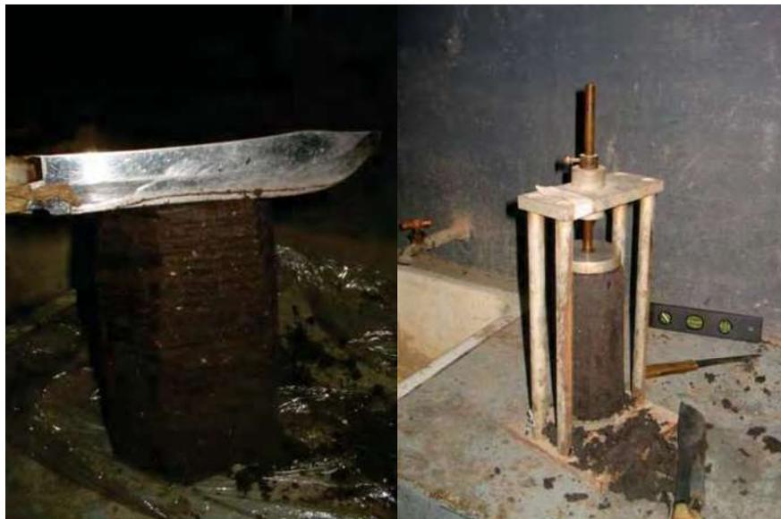
Figura 5-15. Esquema de procedimiento del labrado de la probeta de ensaye.
