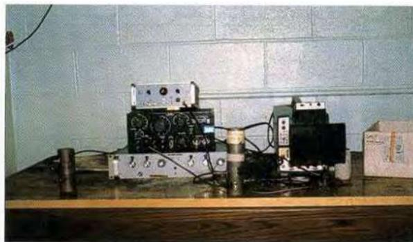
Figura 1-12. Equipo para el ensayo de pulsos ultrasónicos.
