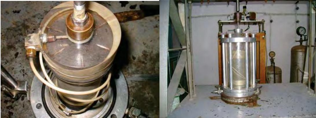
Figura 5-18. a) vista de la probeta de suelo montada en la base de la cámara triaxial. b) vista general de la probeta montada en la cámara triaxial.
