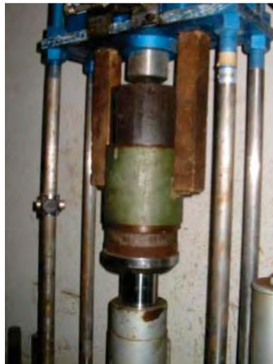
**Figura 5-13. Marco de carga, cilindro de acero y probeta de suelo al momento de desmontarla.**
