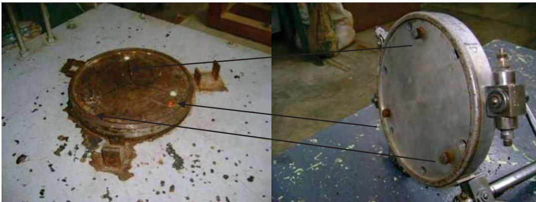
Figura 5-9 Reducción del diámetro de agujeros de tal manera que no exista rozamiento con los tornillos de la tapa inferior de la cámara triaxial.
