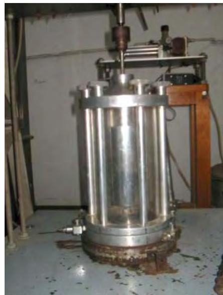
**Figura 5-10** Alineamiento de la cámara con ayuda de una plomada (Izquierda). Alineamiento de la cámara sujetándola con el vástago (derecha).
