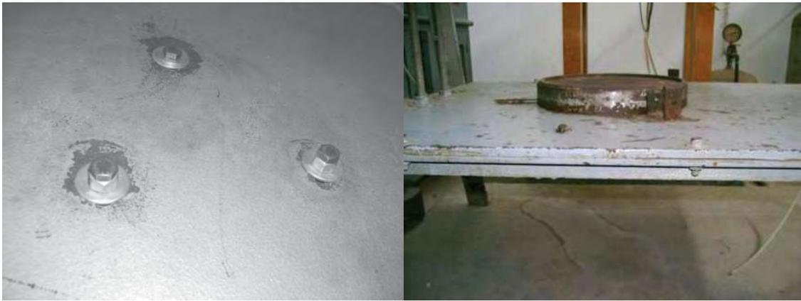
**Figura 5- 6 Sujeción de la placa base con la placa principal del marco (Derecha). Vista de la parte inferior de la placa principal que muestra la disposición de los tornillos (Izquierda).**
