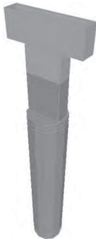
Figura 2-15: Modelo del cabezal, pila, tapa superior, tapa inferior y cilindro con elementos barra (Aguilar y Jara, 2006).
