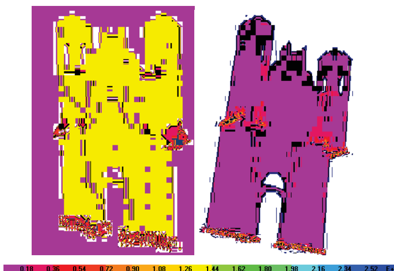
Fig. 5.16 Modelo de elemento finito de la fachada
