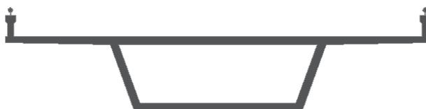
Figura 41 Sección de la superestructura a base de prefabricados
