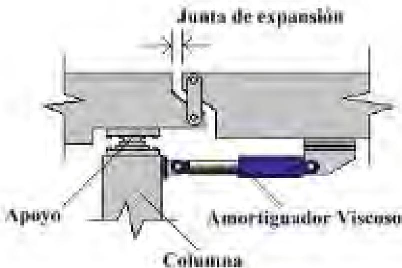
Figura 19 Colocación del amortiguador del tablero con una pila
