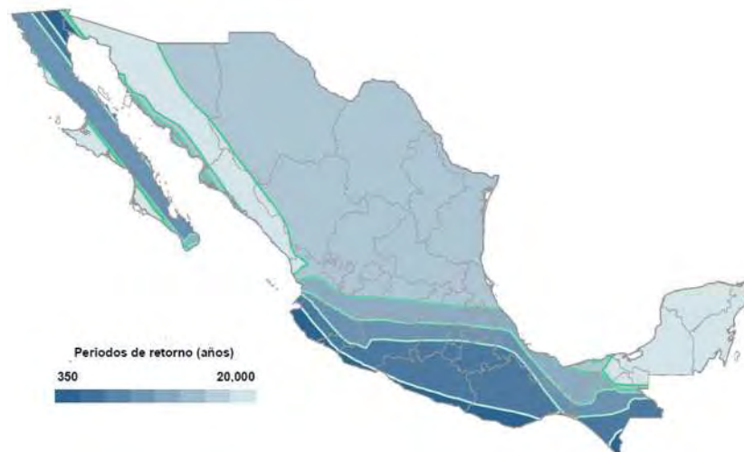
Figura 2.7.2 Mapas de periodos de retorno. Tomada de: Manual de Diseño de Obras Civiles Diseño por Sismo (2008) .
