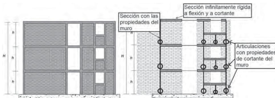
**Figura 2.25** Modelado a través del método modificado de la columna ancha (adaptado de Zúñiga, 2005).
