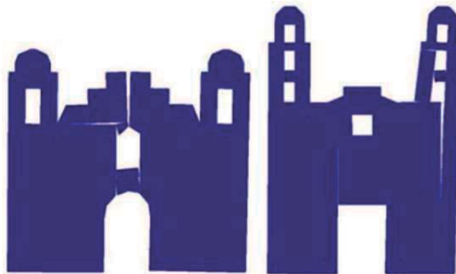
Imagen 2.18. Mecanismo de colapso típico obtenido con un análisis estático no-lineal; Oaxaca (izquierda), Puebla (derecha, Peña y Meza, 2010).
