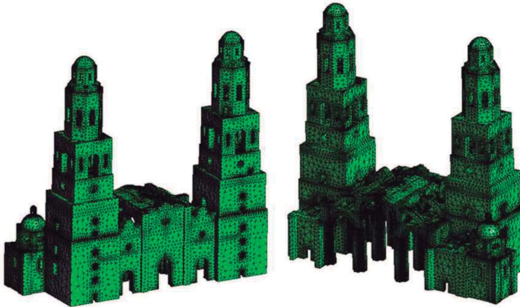
Imagen 2.24. Modelo de elementos finitos para el conjunto torres-fachada (Gaytan et al., 2010).
