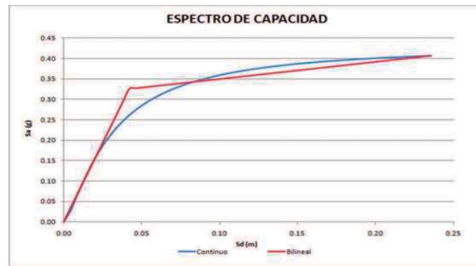
Imagen 2.26. Representación continua y bilineal para la punta de la torre oriente.
