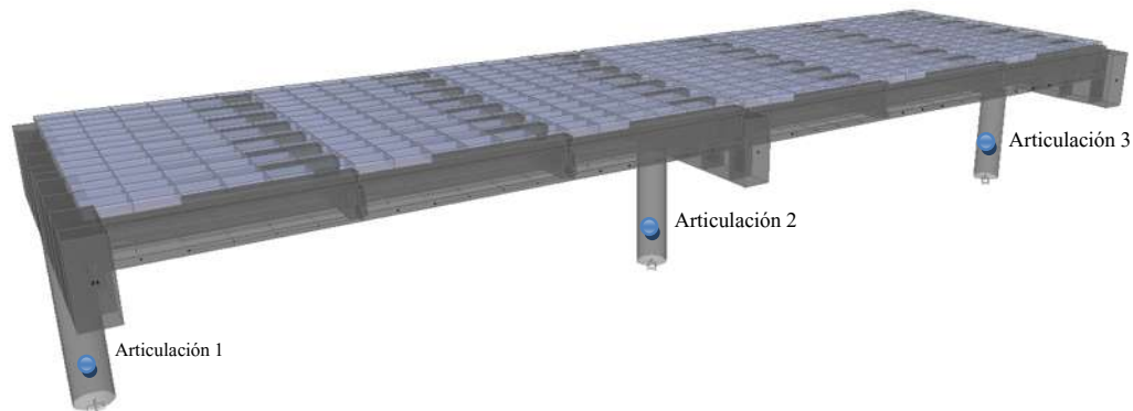
Figura IV-5 Ubicación de articulaciones plásticas en los modelos de los puentes,
