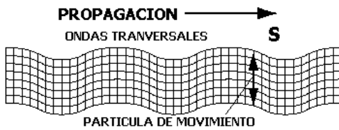
Figura II-11 Esquema de las ondas Secundarias (S). http://www.lpi.tel.uva.es/~nacho/docencia/ing_ond_1/trabajos_06_07/io3/public_html/Ondas/Ondas.html
