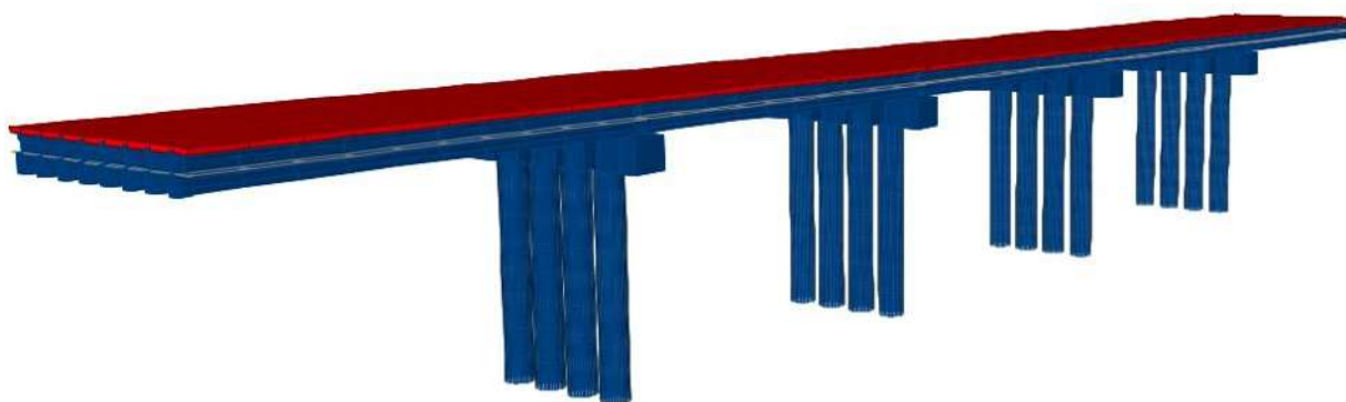
Figura 4.12 Elementos tipo placa (rojo) y elementos tipo barra (azul)
