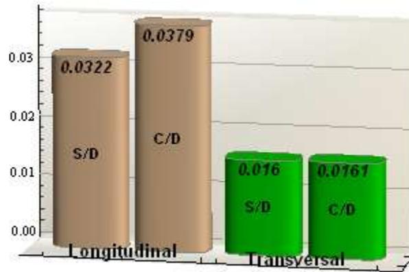
Figura 5.45 – Resultados de la demanda de rotación  $\theta$  (rad) para los modelos con degradación y sin degradación
