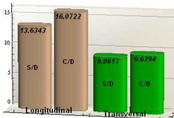
Figura 5.48 – Resultados de la demanda de ductilidad de curvatura  $\mu_\phi$  para los modelos con degradación y sin degradación
