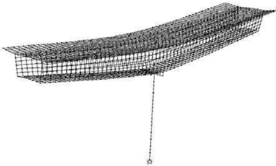
Movimiento vertical de la sección cajón
