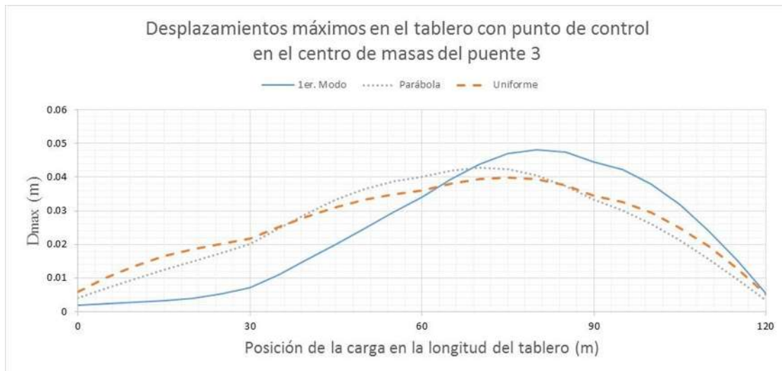
Figura 3.31 Desplazamiento en la parte superior del tablero sobre el eje longitudinal de la sección, bajo tres configuraciones de carga y punto de control en el centro de masas para el puente 3
