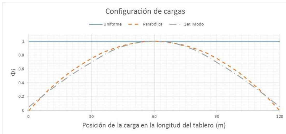
Figura 3.60 Configuraciones de las cargas aplicadas en la parte superior del tablero sobre eje longitudinal de la sección transversal para el puente 7
