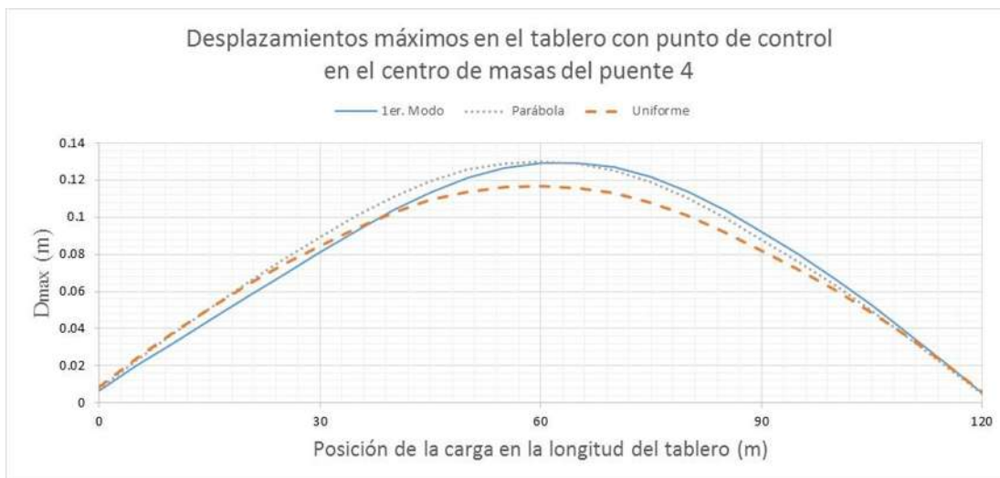
Figura 3.40 Desplazamiento en la parte superior del tablero sobre el eje longitudinal de la sección, bajo tres configuraciones de carga y punto de control en el centro de masas para el puente 4
