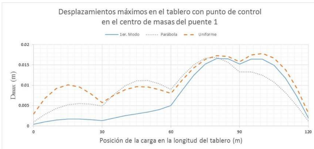
Figura 3.16 Desplazamiento en la parte superior del tablero sobre el eje longitudinal de la sección, bajo tres configuraciones de carga y punto de control en el centro de masas para el puente 1
