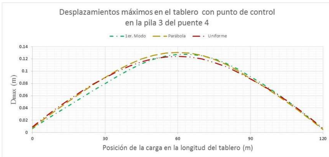
Figura 3.41 Desplazamiento en la parte superior del tablero sobre el eje longitudinal de la sección, bajo tres configuraciones de carga y punto de control en la pila 3 para el puente 4
