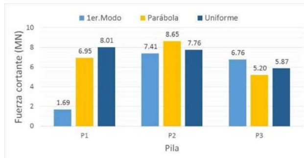
Figura 4.15 Fuerza cortante basal en pilas del puente 1 para los modelos con las combinaciones de carga equivalente al 1er. modo, parabólica y uniforme
