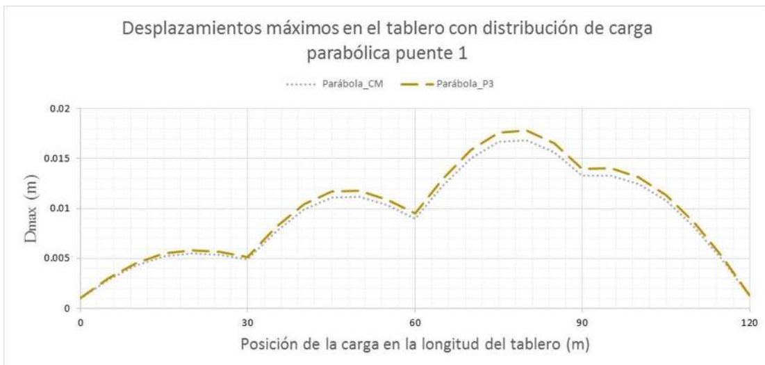
Figura 3.19 Desplazamiento en la parte superior del tablero sobre el eje longitudinal de la sección, bajo carga parabólica con punto de control en centro de masas y en la pila 3 para el puente 1
