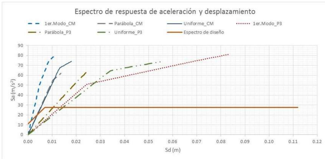
Figura 3.24 Espectro de respuesta de aceleración y desplazamiento para las curvas de capacidad transformadas para un sistema de un grado de libertad equivalente con el método N2 para el puente 2 y para el espectro de respuesta obtenido con PRODISIS
