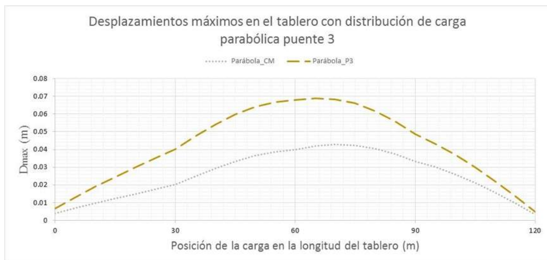
Figura 3.34 Desplazamiento en la parte superior del tablero sobre el eje longitudinal de la sección, bajo carga parabólica con punto de control en centro de masas y en la pila 3 para el puente 3
