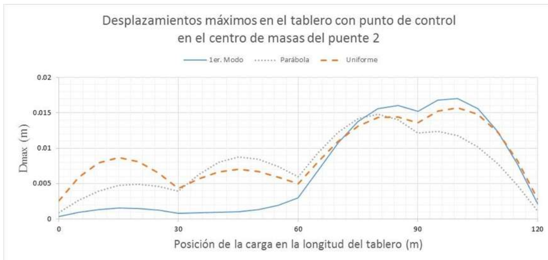
Figura 3.25 Desplazamiento en la parte superior del tablero sobre el eje longitudinal de la sección, bajo tres configuraciones de carga y punto de control en el centro de masas para el puente 2
