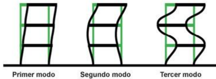
Figura 2.5. Formas modales en el sistema estructural representado por marcos en tres niveles.
