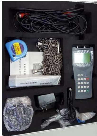
Figura 65.- Equipo ultrasónico utilizado en el aforo de tubería principal en el laboratorio de hidráulica
