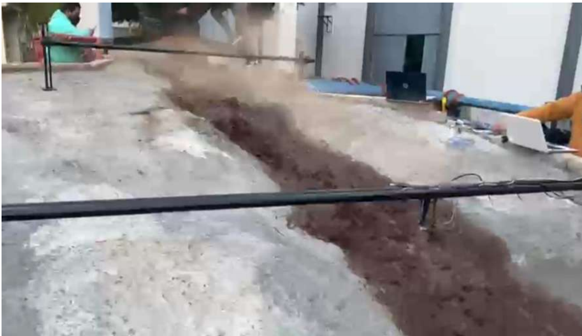
Figura 99. Perspectiva de la simulación de flujo de detritos para un Tr=25 años a una apertura de la escotilla de 15 cm.
