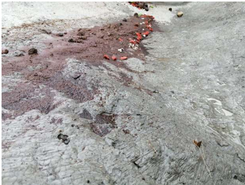
Figura 128. Depósito de material a la margen en el cauce del modelo
