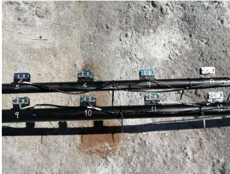
Figura 63.- Acomodo de sensores ultrasónicos para definir la velocidad de la onda de flujos de detritos sobre la sección transversal 0+040.
