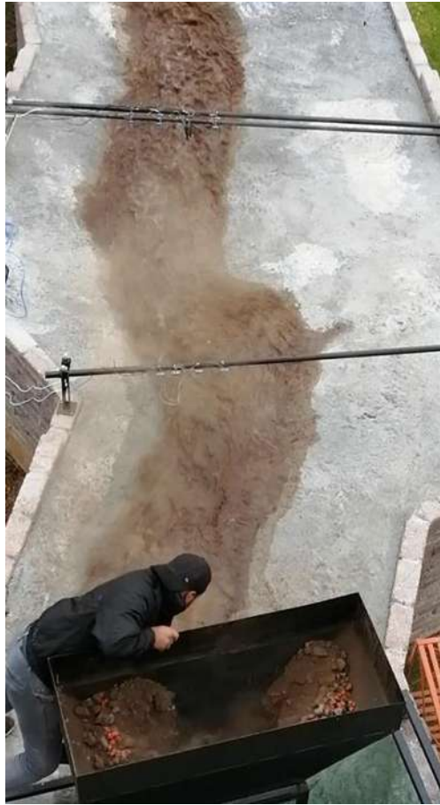
Figura 96. Simulación en condiciones de detritos (vista en planta) para un Tr=25 años y una apertura de la escotilla de 12 cm.
