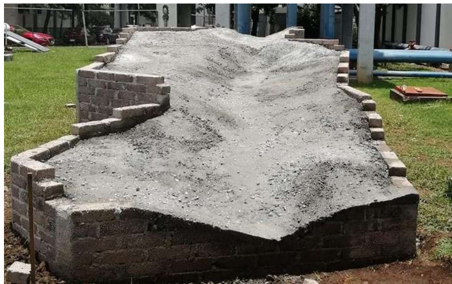
Figura 50.- Panorámica del modelo de flujo de detritos construido. Escala geométrica 1:10.
