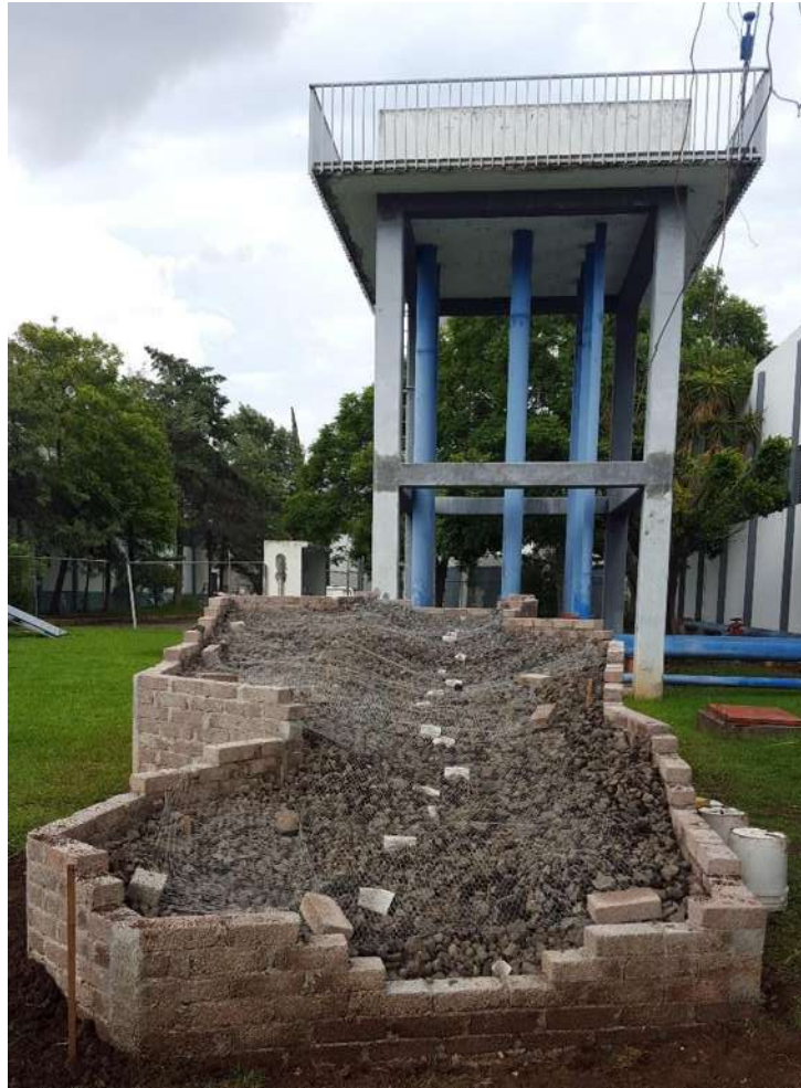
Figura 48.- Colocación de malla hexagonal sobre la superficie de relleno del modelo hidráulico.
