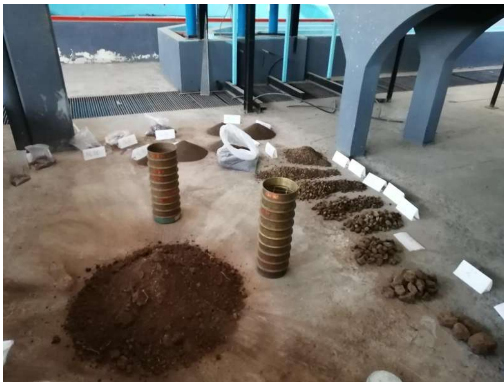
Figura 55. Separación por su tamaño de partículas del material utilizado en las pruebas de flujo de detritos.
