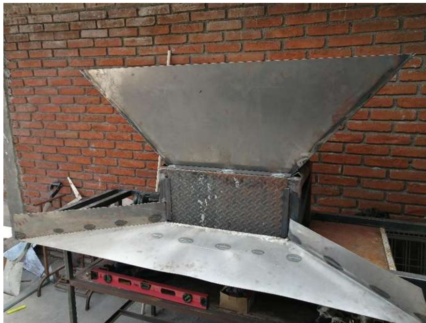
Figura 76. Fabricación de la tolva para descarga de material pétreo.
