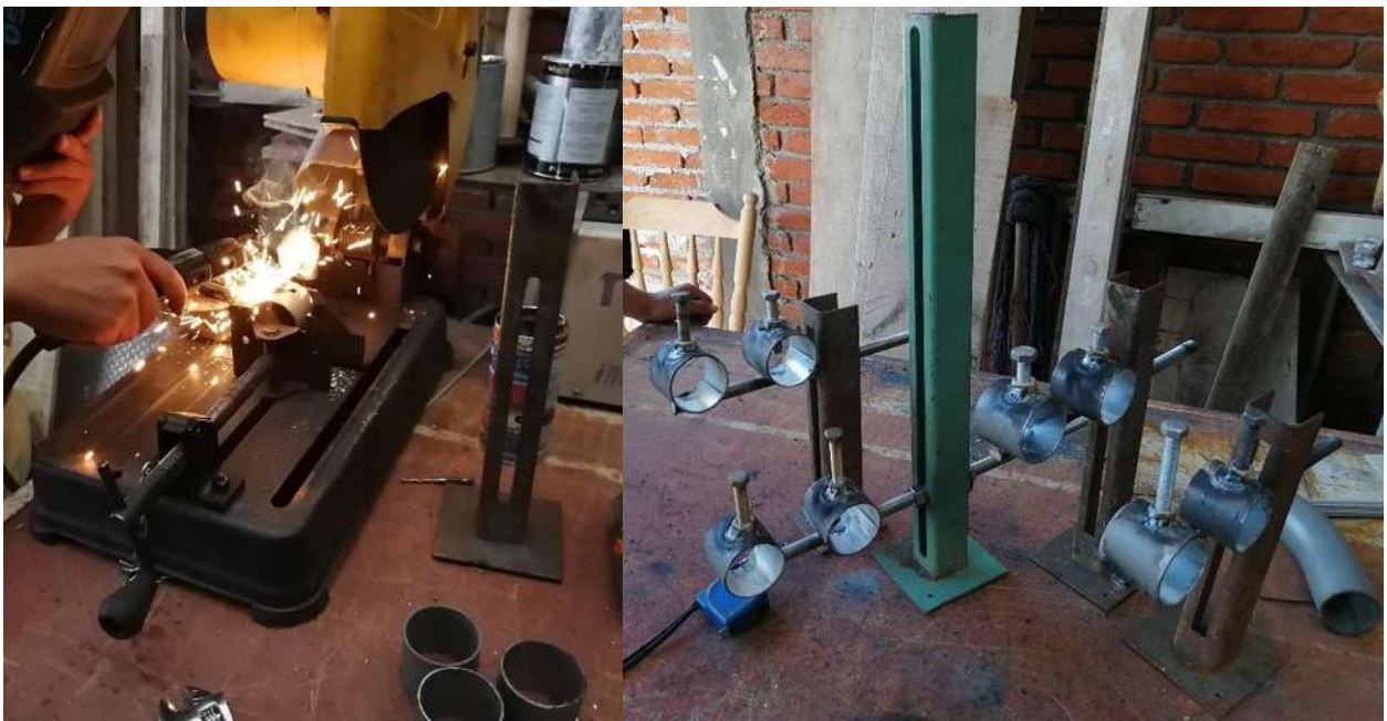
Figura 60. Fabricación de bases o soportes de acero para el montaje de los sensores ultrasónicos HC-SR04.
