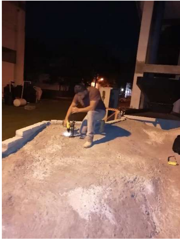
Figura 61. Montaje de soportes de acero sobre el modelo físico.
