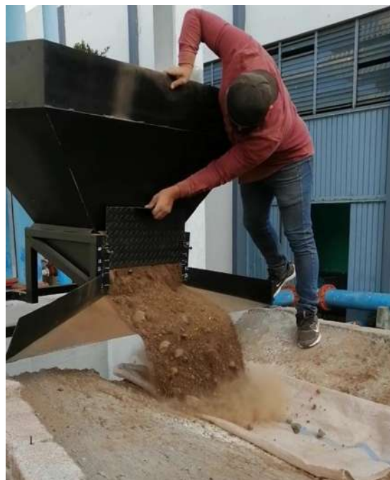
Figura 78. Ensayo de descarga de material pétreo a una apertura de 12.5 cm.
