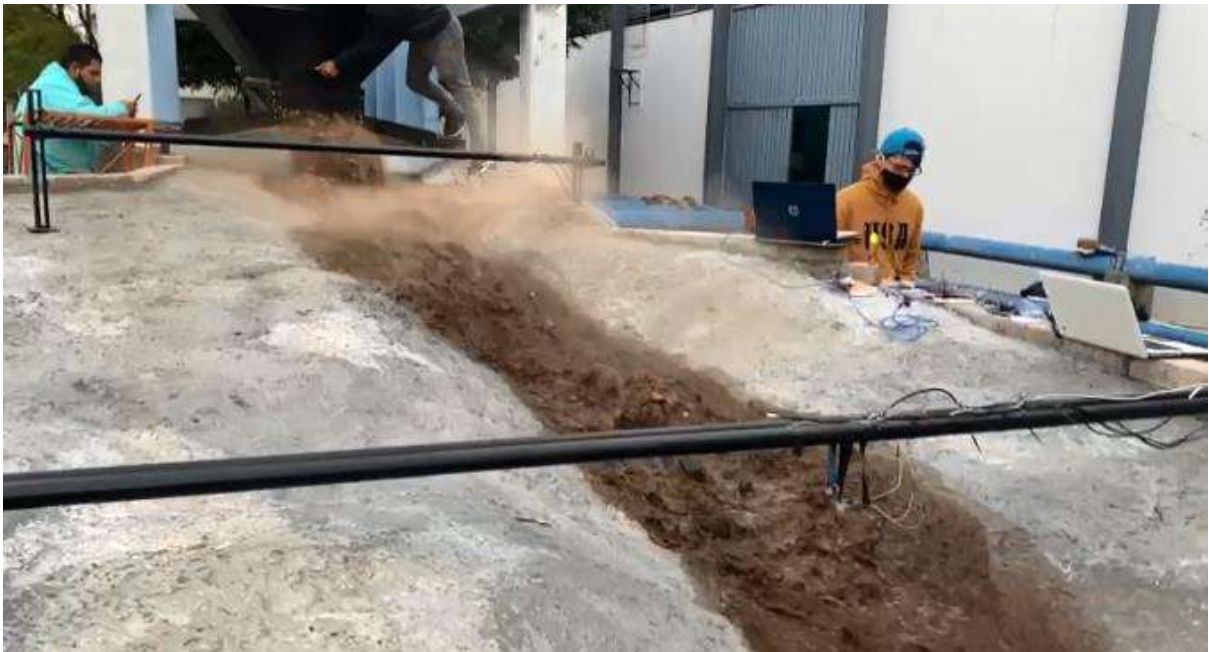
Figura 97. Perspectiva de la simulación en condiciones de flujo de detritos para un Tr=25 años y apertura a 12 cm.
