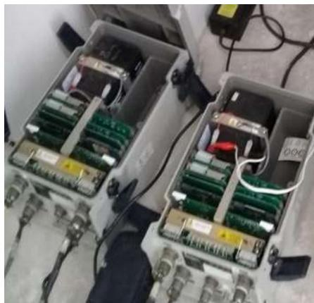
Figura 7. 47 Equipo de medición: digitalizadores
