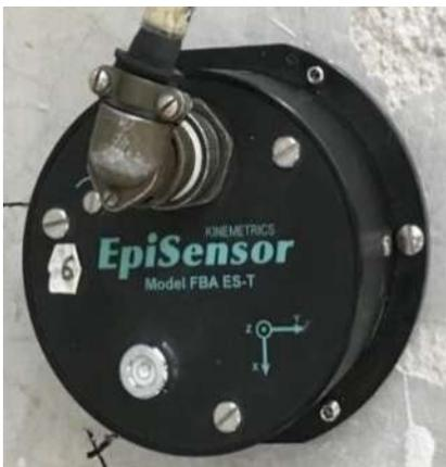
Figura 7. 46 Equipo de medición: acelerómetro triaxial
