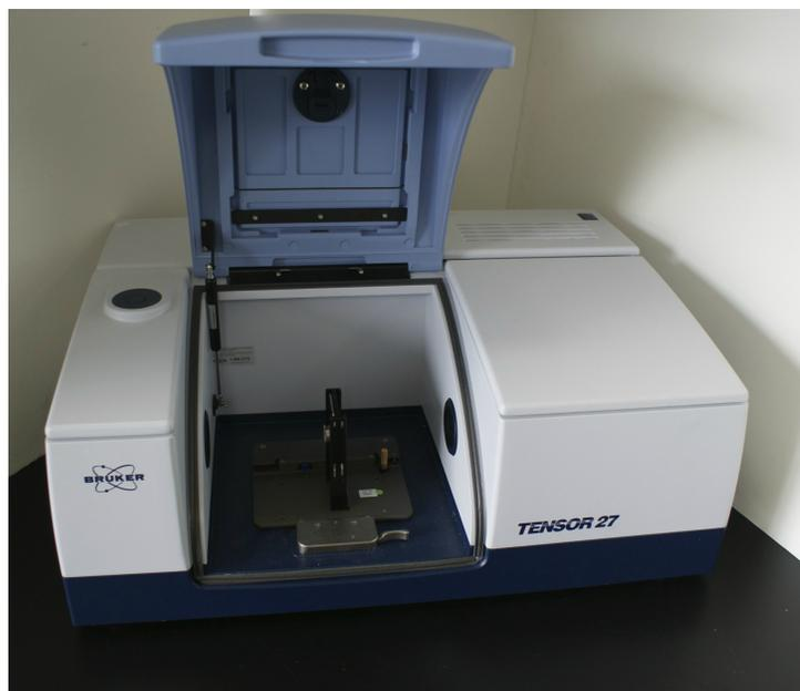
Figura 3.13: Espectrofotómetro de infrarrojo modelo Tensor 27 de la marca Bruker.
