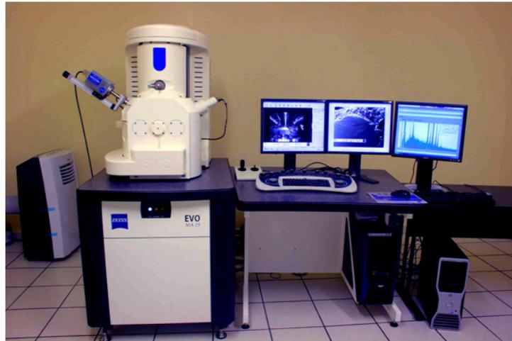
Figura 3.15: Microscopio electrónico de barrido marca Zeiss, modelo EVO MA10 equipado con Detector de rayos X marca Bruker, modelo XFlash 30.
