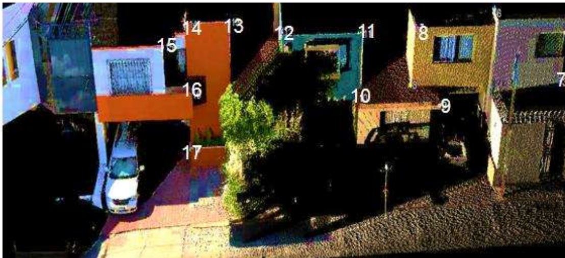
Figura 24. Nube de Puntos Chapultepec, en donde se aprecian fachadas de casas sin afectación de subsidencia y sobre ellas puntos de control enumerados que se colocaron para georeferenciar con la nube obtenida el 9 de noviembre del 2015 de la misma calle.
