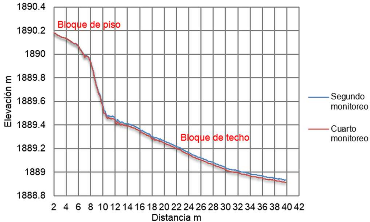
Figura 38. En la imagen se aprecia los perfiles correspondientes al segundo monitoreo y cuarto monitoreo hecho en la calle Halcón, la zona de los perfiles correspondientes al bloque de piso (distancia 0-7.00m) se encontraron al mismo nivel sin hundimiento o elevación, dado que en esta zona no existe hundimiento. Pero a partir de la distancia 10m se observó que inicia un descenso del perfil correspondiente al cuarto monitoreo (perfil rojo) provocado por el cruce de la falla La Colina, en esta distancia se aprecia descenso de parte del perfil rojo identificado como subsidencia local.
