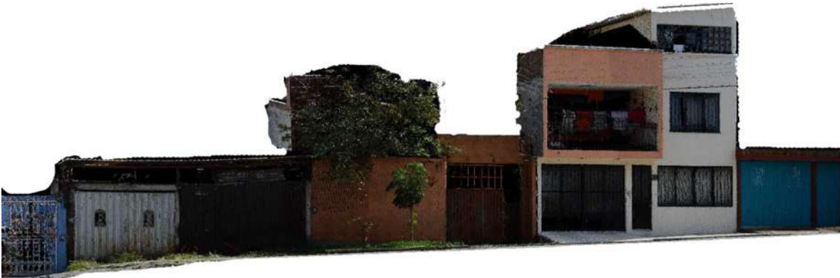
Figura 34. Imagen nube de puntos en perfil monitoreada en la calle Halcón, dicha nube ya fue limpiada con el programa Riscan Pro en donde se eliminaron obstáculos como carros y cables de luz.
