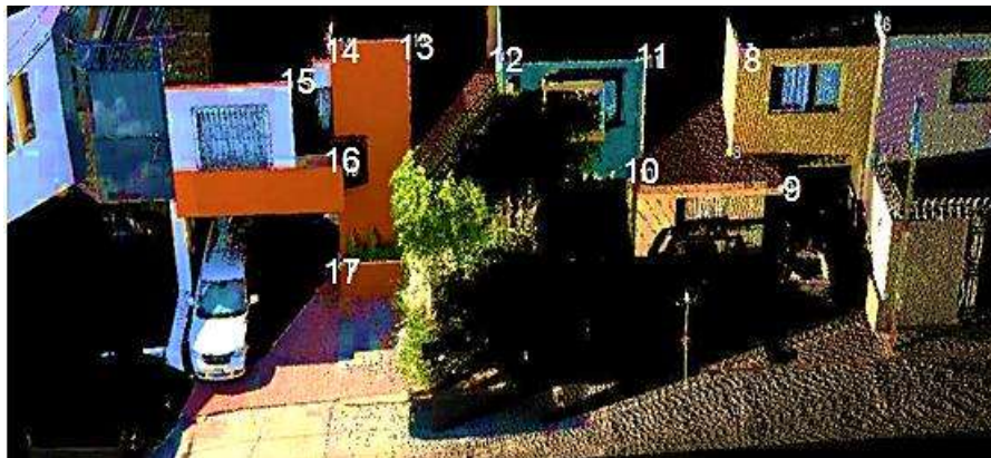
Figura 17. Imagen tomada de la nube de puntos correspondiente a la calle Juan de Grijalva en donde se aprecian las fachadas de las casas, los números representan los tp (puntos de control) colocados con el programa Riscan pro, las zonas oscuras que se aprecian corresponden a las partes en donde obstáculos no permitieron el escaneo con el láser.
