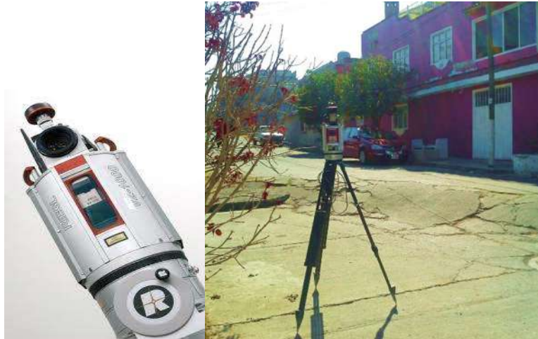
Figura 13. En la imagen de la izquierda se muestra el Escáner Laser Terrestre VZ-1000 integrado con su cámara y antena WiFi, equipo utilizado en este trabajo de investigación, en la imagen de la derecha se aprecia el equipo montado sobre el tripie, listo para realizar un monitoreo.
