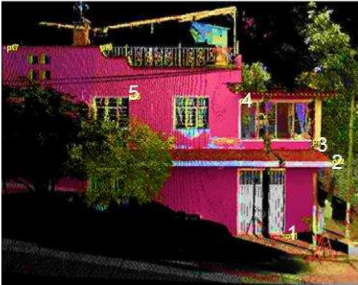
Figura 33. Nube de puntos correspondientes a la calle Halcón, en donde se aprecia la fachada de una casa sin afectación de subsidencia y sobre ellas puntos de control enumerados que se colocaron para unir la nube de puntos de ese monitoreo con el resto.
