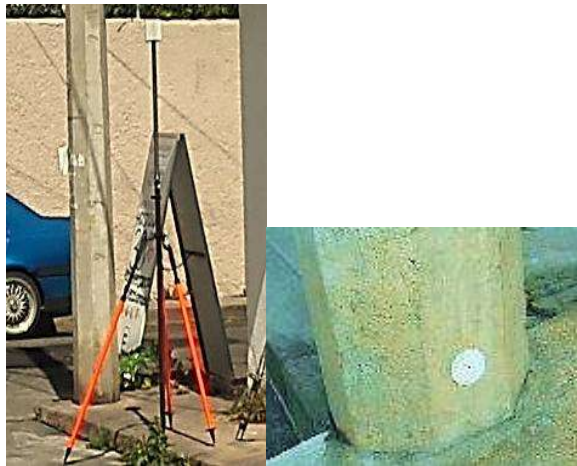
Figura 14. En la imagen de la izquierda se aprecia el reflector cilíndrico de plástico montado sobre baliza y tripie. En la imagen de la derecha se aprecia el reflector de etiqueta plástica, colocado en un poster de luz.
