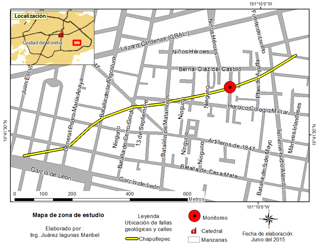
Figura 10. Mapa de ubicación donde se colocó el Escáner Laser Terrestre (círculo rojo) sobre la calle Juan de Grijalva, para el monitoreo de la falla Chapultepec representada por una línea amarilla, fuente Inegi marco geoestadístico 2010 y Atlas de riesgos del estado de Morelia, Michoacán.
