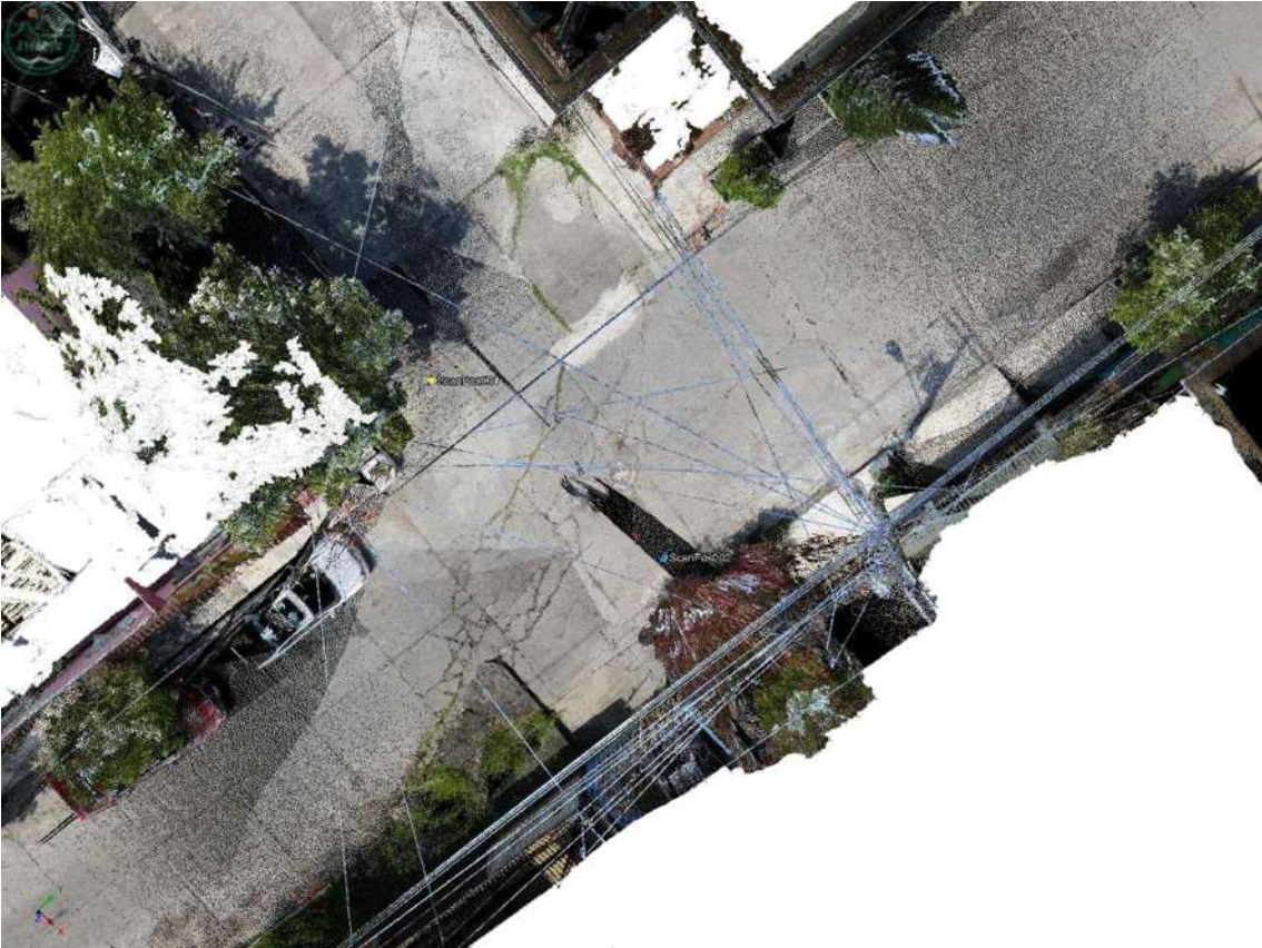
Figura 35. Imagen de nube de puntos en planta escaneada en la calle Halcón en donde se aprecia la imagen sin ninguna modificación. Es resultado crudo del monitoreo con el E.L.T, se logra apreciar árboles, trazas de línea que son los cables de luz.
