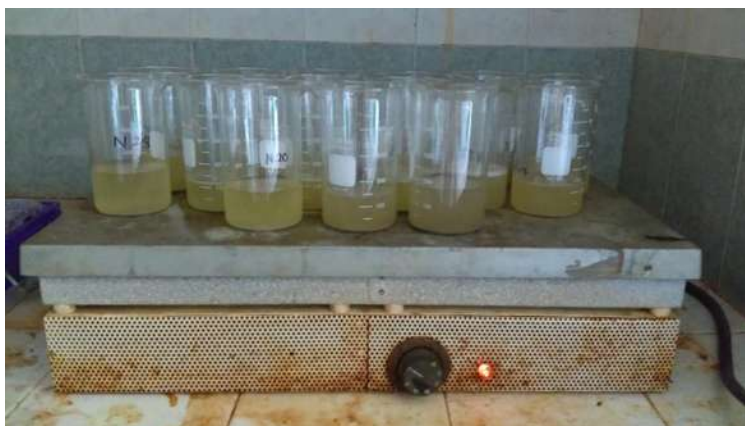
Figura 26. Tratamiento de limpieza de las muestras colectadas en campo, con ayuda de HCl y H 2 O 2 . La muestra se calienta para agilizar la digestión de los ácidos.
