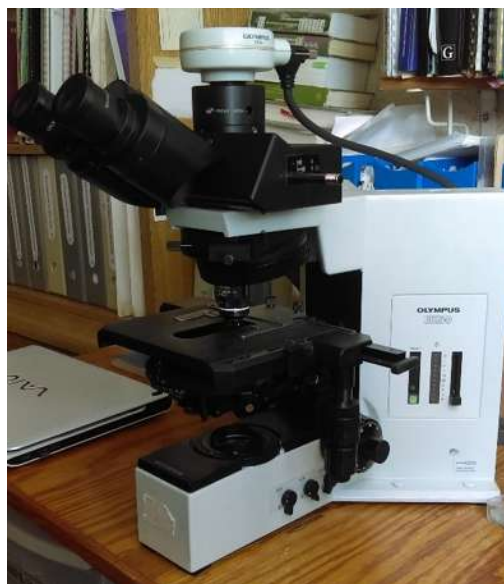
Figura 27. Microscopio de luz Olympus BX50, utilizado para el conteo y descripción de las diatomeas presentes en las muestras de la CLP.
