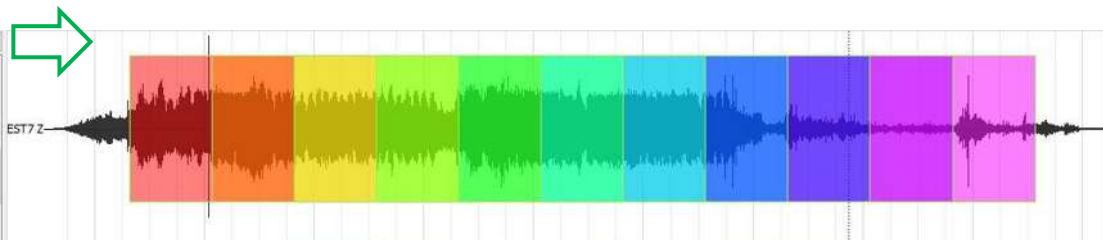
Figura 53. Selección de las ventanas de tiempo en la componente vertical de un sensor para el análisis del cociente H/V (franja coloreada).
