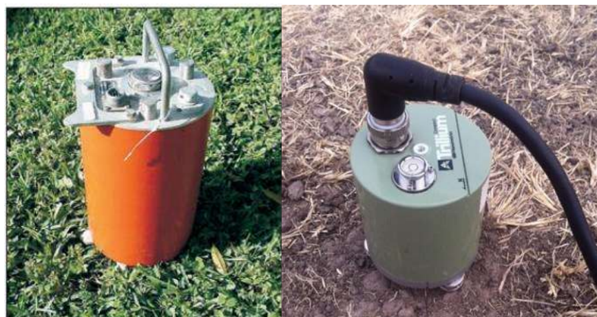
Figura 24. A la izquierda un modelo de sismómetro período corto S-13. A la derecha el sismómetro de banda ancha Trillium Compact 120s . Ambos instrumentos son utilizados en la captación de la señal sísmica.
