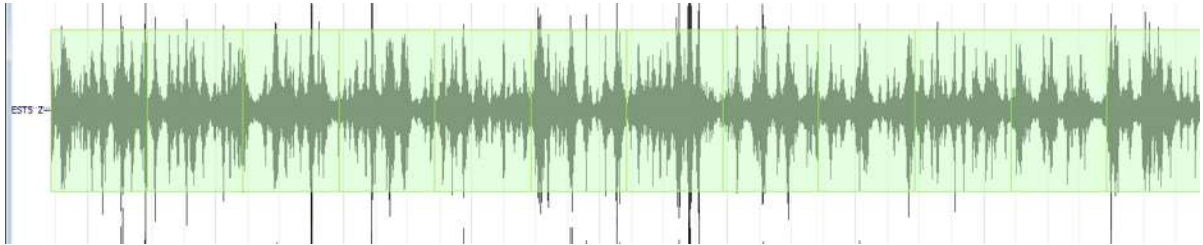
Figura 52. Selección automática de ventanas de 900 s para registros de 3 hr en la componente vertical de un sensor (franja verde).
