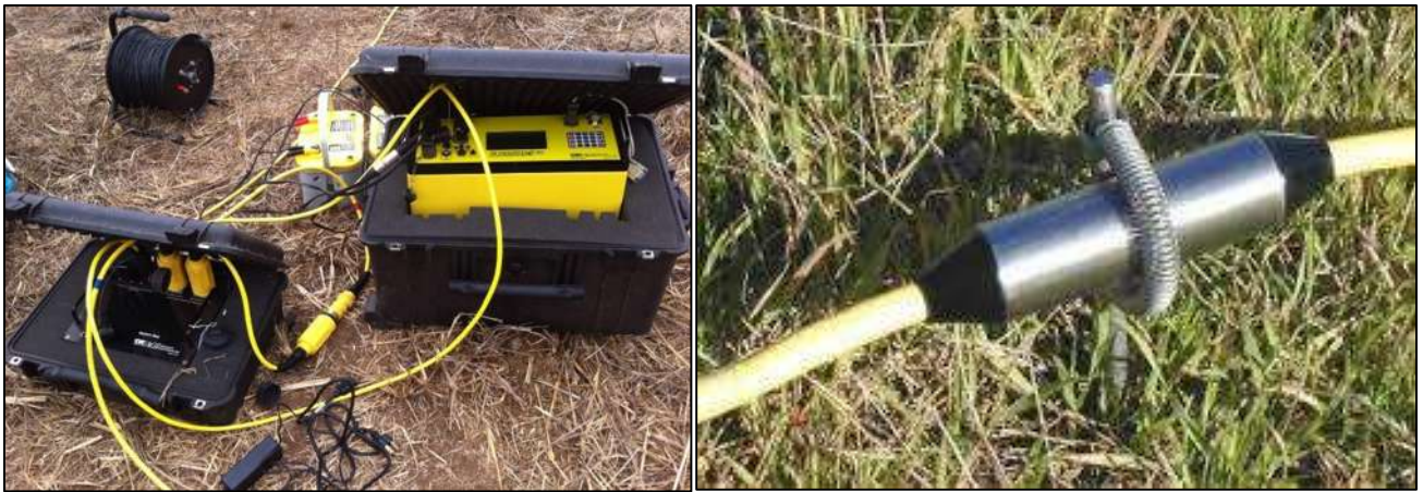
Figura 12.- Equipo SuperSting R1 Electrical Resistivity IP/SP Meter, electrodos, cableado, unidad central, baterías.
