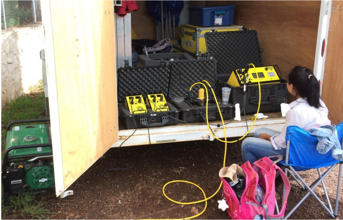
Figura 28.- Equipo SuperSting R1 que fue utilizado para realizar las mediciones en cada perfil.
