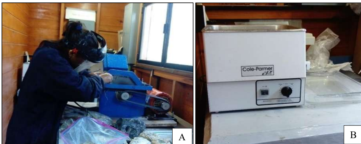
Figura 29.- Trabajo de laminado. A) Cortado de las muestras de roca utilizando la cortadora Buehler. B) Lavado ultrasónico para eliminar restos de abrasivo.
