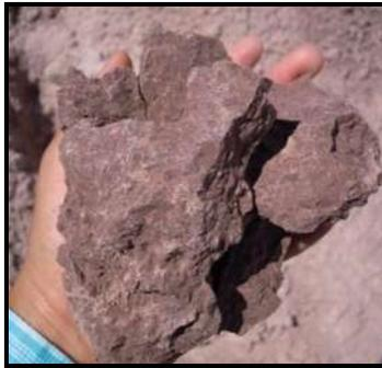
**Figura 27.** Limoarcillas masivas en muestra de mano.
