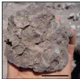
**Figura 30.** Limo arenoso en muestra de mano (escala 2.5 cm)
