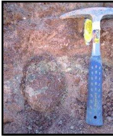
**Figura 12.** Bloque de paleosuelo para extracción de muestra inalterada.
