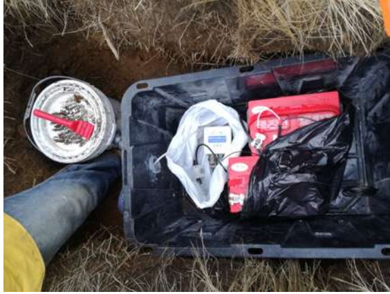
Figura 4.5: Instalación de digitalizador Cube3
