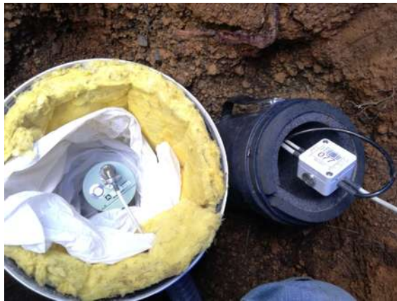
Figura 4.4: Instalación de sensor Trillium Compact 120s en cubeta plastica recubierta con fibra de vidrio
