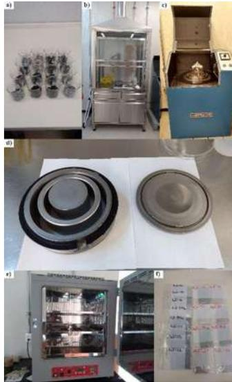
**Figura 5.** Material empleado durante la preparación de las muestras para su análisis geoquímico. a): vasos de precipitado con esquirlas de muestras; b) campana de extracción; c) trituradora HERZOG; d) anillos para pulverización tipo grinding vessel; e) horno tipo Shel Lab (SL); f) muestras preparadas y empaquetadas para su envío al laboratorio.
