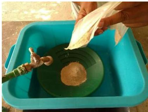
**Figura 6.** Preparación de muestra mediante bateo para separar zircones.
