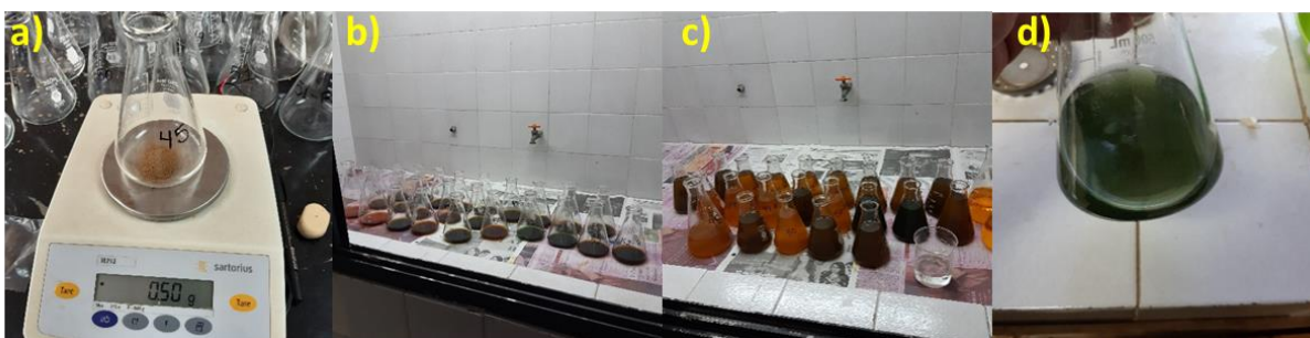
Figura 22. Proceso de determinación de carbono orgánico (%).
